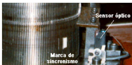
Figura 3.5. Pormenor do sensor óptico.
