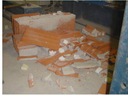
Figura 7.25: Rotura de um provete. Rotura completa das fiadas superiores
