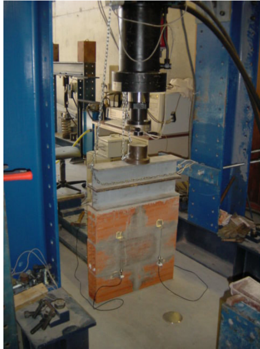
Figura 7.23: Provete montado na máquina de ensaio
