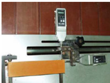
Figura 3.14: Aspecto do ensaio de determinação da expansão por humidade segundo a norma EN 772-19 [20, 28]
