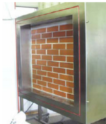
Figura 3.15: Aspecto do ensaio de determinação da resistência ao gelo e degelo, segundo a norma EN 772-22 [20, 29]
