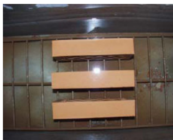
Figura 3.10: Aspecto geral do ensaio de determinação da absorção de água por imersão segundo a norma NP EN 772-7 [20, 24]
