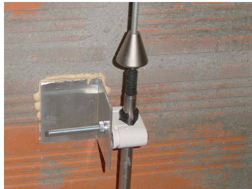
Figura 7.20: Montagem de um transdutor no provete
