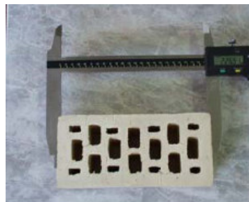
Figura 3.13: Determinação das dimensões de um tijolo [20, 27]
