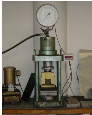
Figura 7.11: Vista geral da máquina de ensaio à compressão
