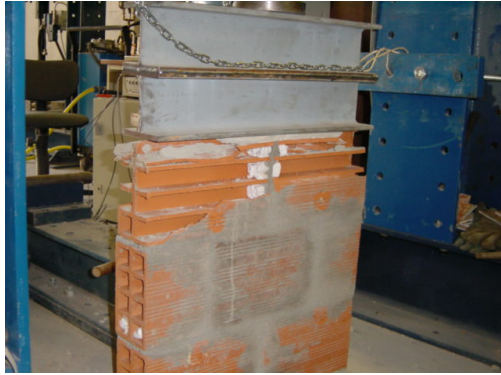
Figura 7.24: Rotura de um provete. Rotura pelos septos exteriores
