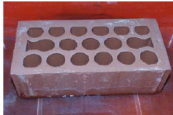
Figura 3.11: Aspecto geral do ensaio de determinação da absorção de água por capilaridade segundo a norma NP EN 772-11 [20, 25]
