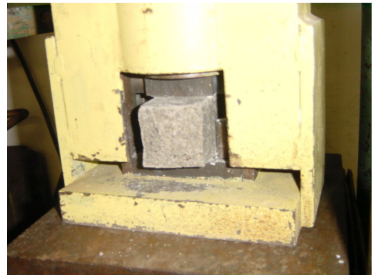
Figura 7.12: Provete de argamassa colocada na máquina de ensaio à compressão
