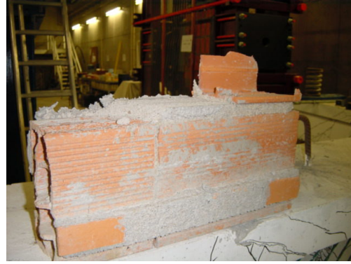
Figura 7.33: Pormenor de superfície de rotura paralela às juntas de assentamento
