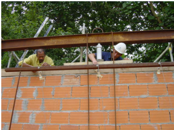
Figura 8.7: Viga superior destinada à mobilizar a reacção do macaco hidráulico. Tirantes na zona de aplicação do macaco
