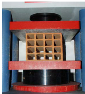
Figura 3.7: Tijolo colocado na máquina de compressão para realização do ensaio segundo a norma NP EN 772-1 [20, 21]
