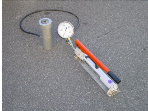
Figura 8.2: Imagem do macaco hidráulico usado nos ensaios
