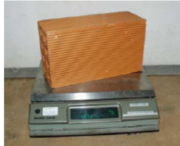
Figura 3.12: Aspecto de uma das fases do ensaio referente à determinação da massa volúmica segundo a norma NP EN 772-13 [20, 26]
