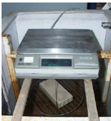
Figura 3.8: Pesagem hidrostática segundo a norma NP EN 772-3 de um tijolo [20, 22]
