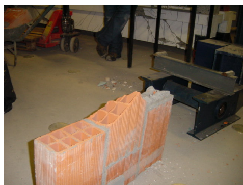
Figura 7.31: Pormenor de superfície de rotura perpendicular às juntas de assentamento
