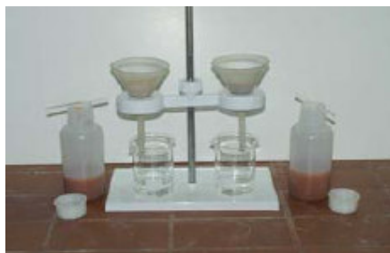
Figura 3.9: Aspecto geral dos utensílios usados na análise do teor em sais solúveis segundo a norma EN 772-5 [20, 23]
