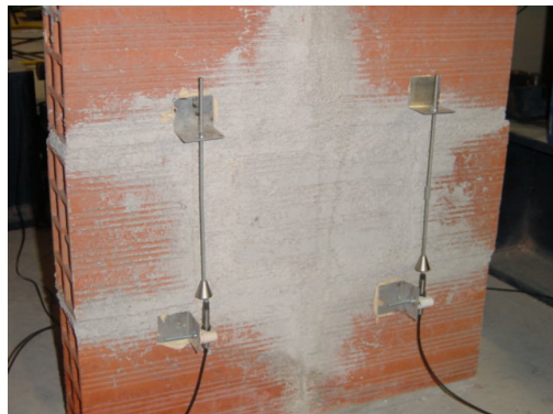
Figura 7.22: Provede montado com os transdutores
