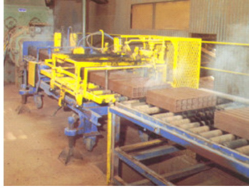
Figura 3.3: Tijolos crus à saída da mesa de corte [18]
