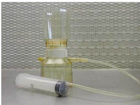
3. Com o auxílio de uma pinça previamente mergulhada em álcool e flamejada, colocar uma membrana estéril entre o funil e o seu suporte, com o retículo virado para cima.
