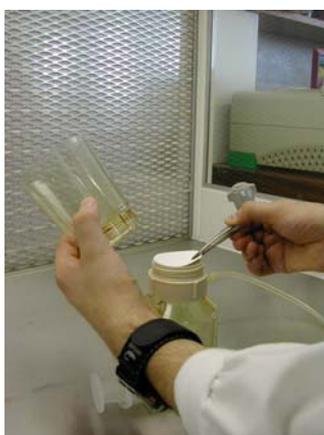
4. Introduzir o volume adequado da amostra a analisar (1, 10, 50 ou 100 ml) no funil e filtrar, utilizando uma seringa ou ligando uma bomba de vácuo. O volume de amostra depende do tipo de água a analisar. Para água de redes de abastecimento é aconselhável a filtração de 100 ml. Para águas de rios ou lagos, o volume de amostra deve ser diminuído e completado a 100 ml (no funil) com água esterilizada.
