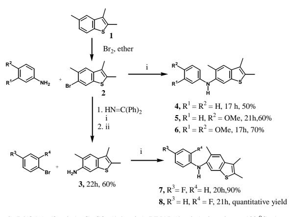
i)  $Pd(OAc)_2$  (3mol%),  $Cs_2CO_3$  (1.4equiv.), BINAP (4mol%), dry toluene, 100 °C, Ar ii) HCl 2M/THF
