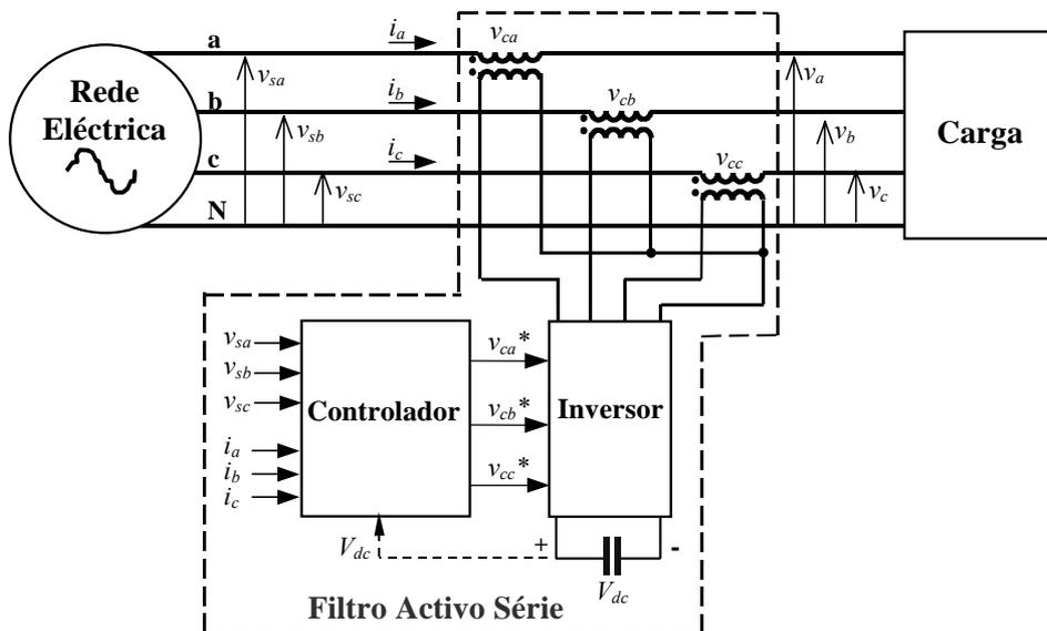
Figura 7 – Esquema de um filtro activo série.
