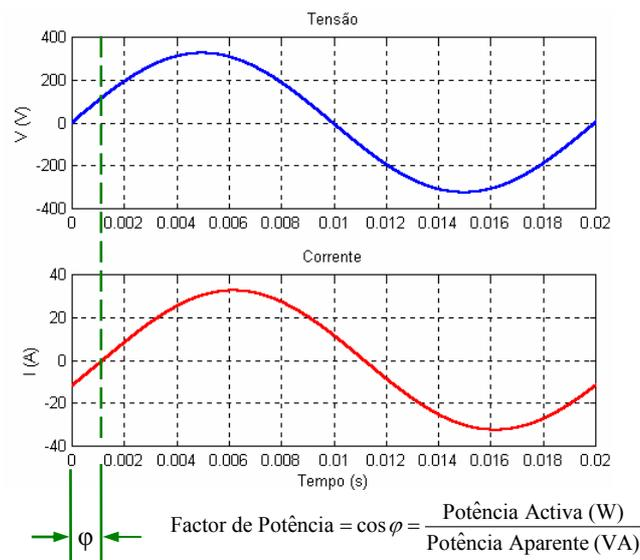
Figura 1 – Tensão e corrente para um sistema eléctrico com cargas lineares.
