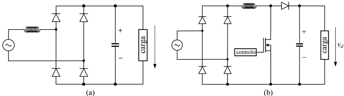
**Figura 4** – Soluções para redução dos harmónicos de corrente à entrada dos equipamentos:
