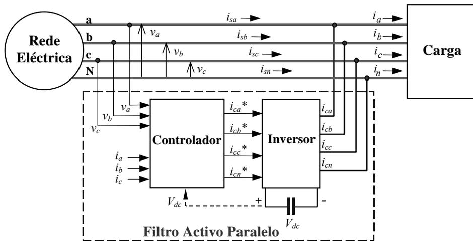
Figura 6 – Esquema de um filtro activo paralelo.
