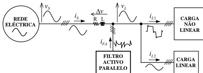
Figura 5 – Filtro activo paralelo: exemplo de operação.
