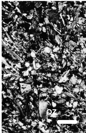
Fig. 5.34 - Lama 2 (de sedimentação) Saibreira do MONTE DE VASCONCELOS. Fotografias 4:30 e 5:0 da Tabela 5.3. (Escala = 200 µm)
