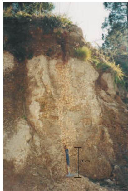
Fig. 2.20 e 2.21 - Pormenor dos solos de cobertura dos maciços explorados e a gradação da cor do granito no sentido topo- profundidade.
