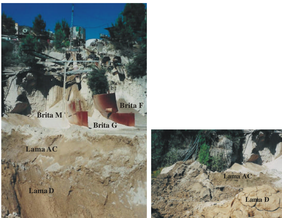
Figs 2.27 e 2.28 - Patamar principal da Saibreira do Monte de Vasconcelos – Zona de armazenamento de triturados para venda e de decantação das águas de britagem. (Locais de amostragem dos triturados e lamas).
