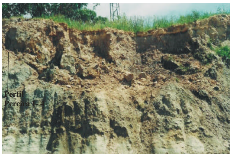
Fig. 2.41 e 2.42 - Perfil do Barreiro de Papagaios cuja superfície tem origem na acumulação de lamias de britagem de saibro externo à exploração, que teve e tem lugar numa cota superior.
