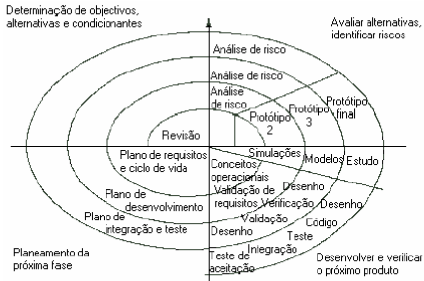
Figura 3 - Modelo de Desenvolvimento de Software (adaptado de [Boehm '88])
