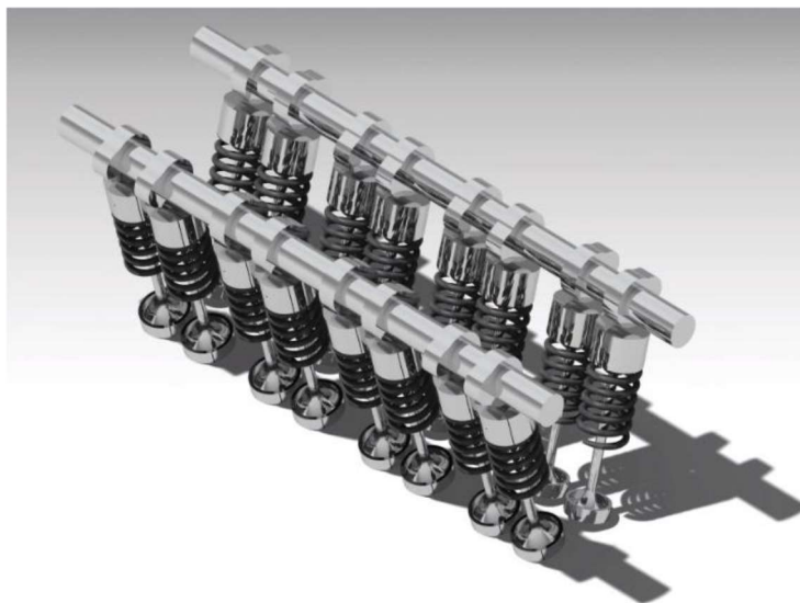
Figura 2.1.1.3: Modelo del Mecanismo de Distribución. (Galán Alcón & Fdez-Puente Sarriá, 2016)
