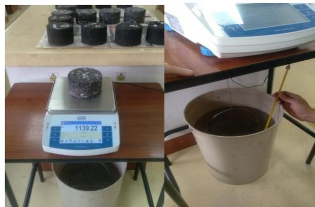
**Figura 6.** a) Muestra en el aire, b) Masa sumergida para ensayo de Densidad Bulk
