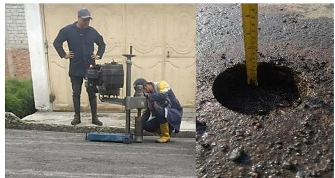
Figura 4. a) Extracción de núcleos mediante taladrado, b) Orificio hecho por el taladrado
