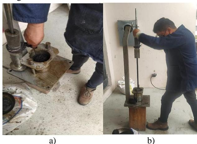
Figura 2. a) Adecuación del material en el molde, b) Compactación manual de probetas in situ
