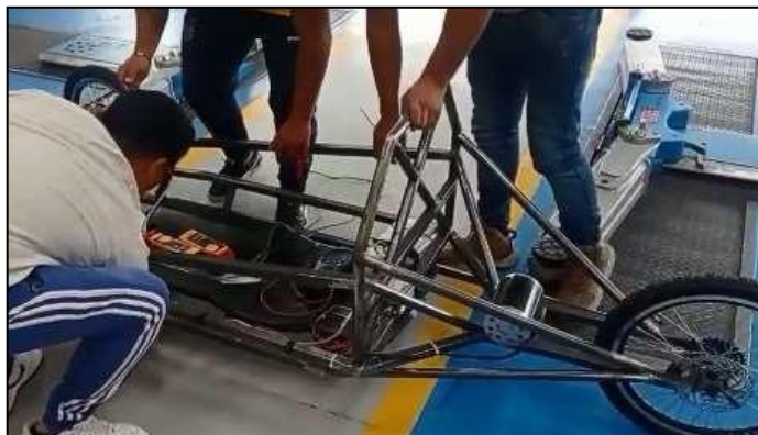
Anexo 12. Implementación de elementos electrónicos en el prototipo, taller de Ingeniería Automotriz, Universidad Politécnica Salesiana, 2022.
