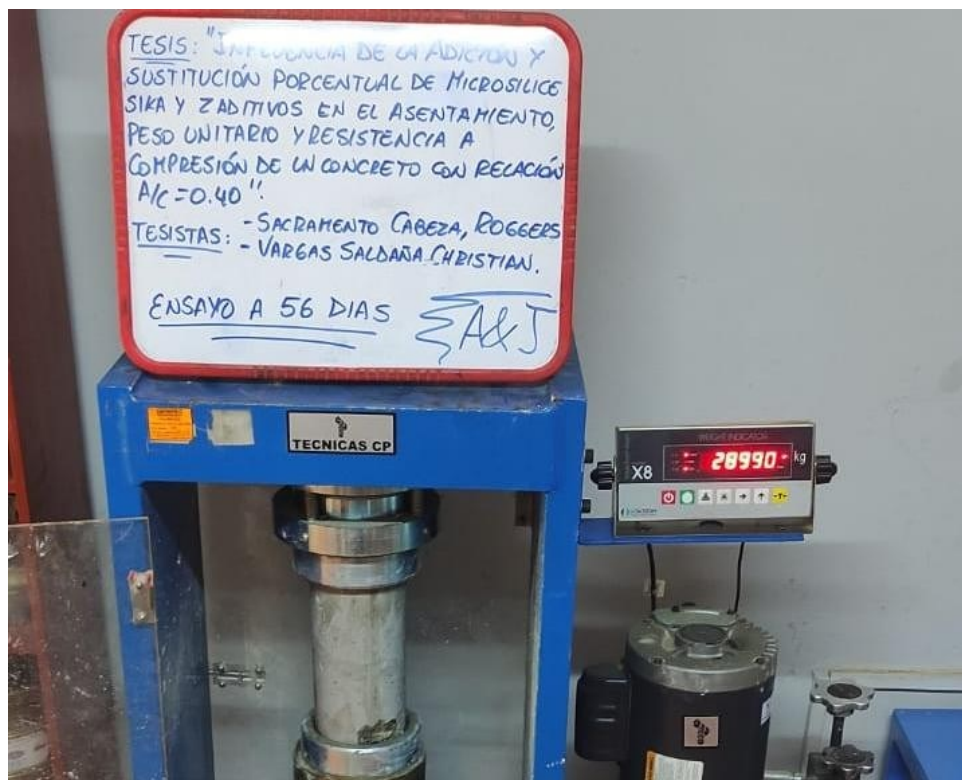
Figura 51. Ensayo de Resistencia a compresión, 56 días con sustitución de MicrosílicaZ al 3%
