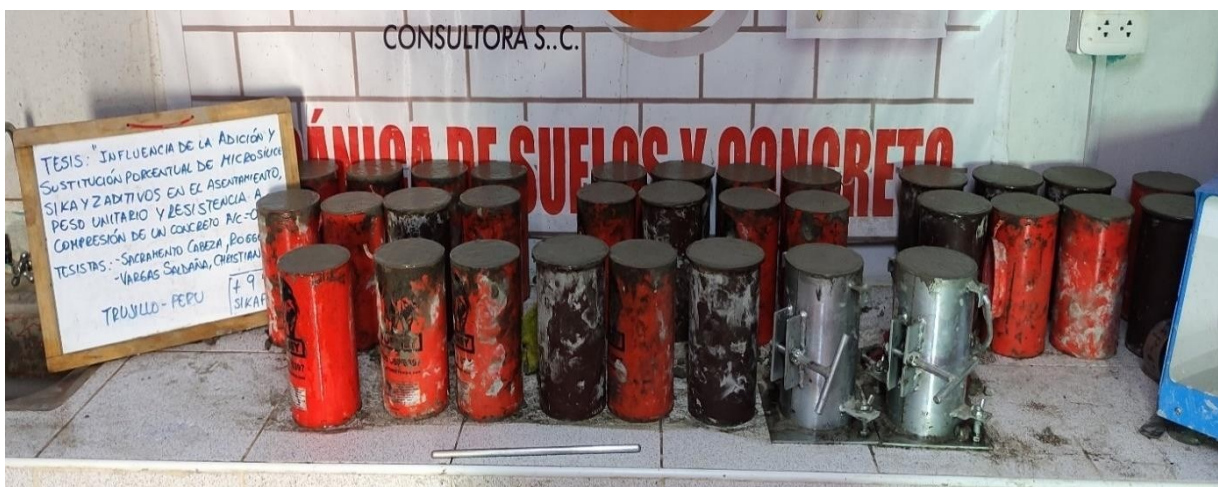
Figura 08. Confección de probetas cilíndricas de 4" x 8",
