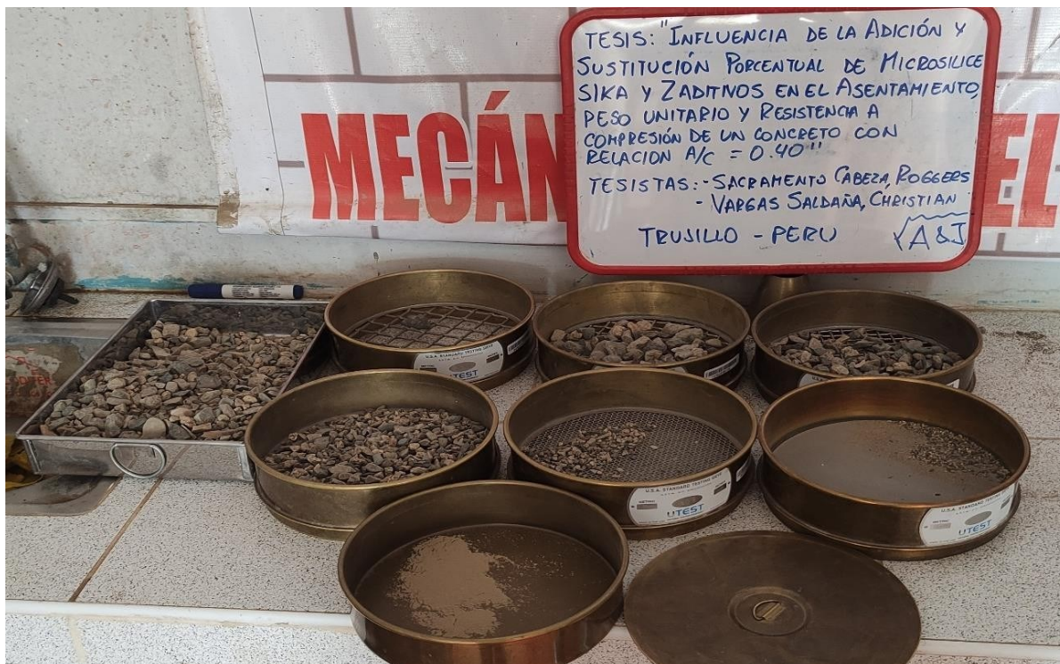
Figura 01. Ensayos de Granulometría del agregado grueso.
