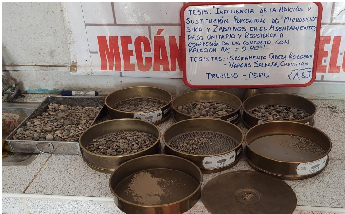
Figura 01. Ensayo de Granulometría para el agregado grueso.
