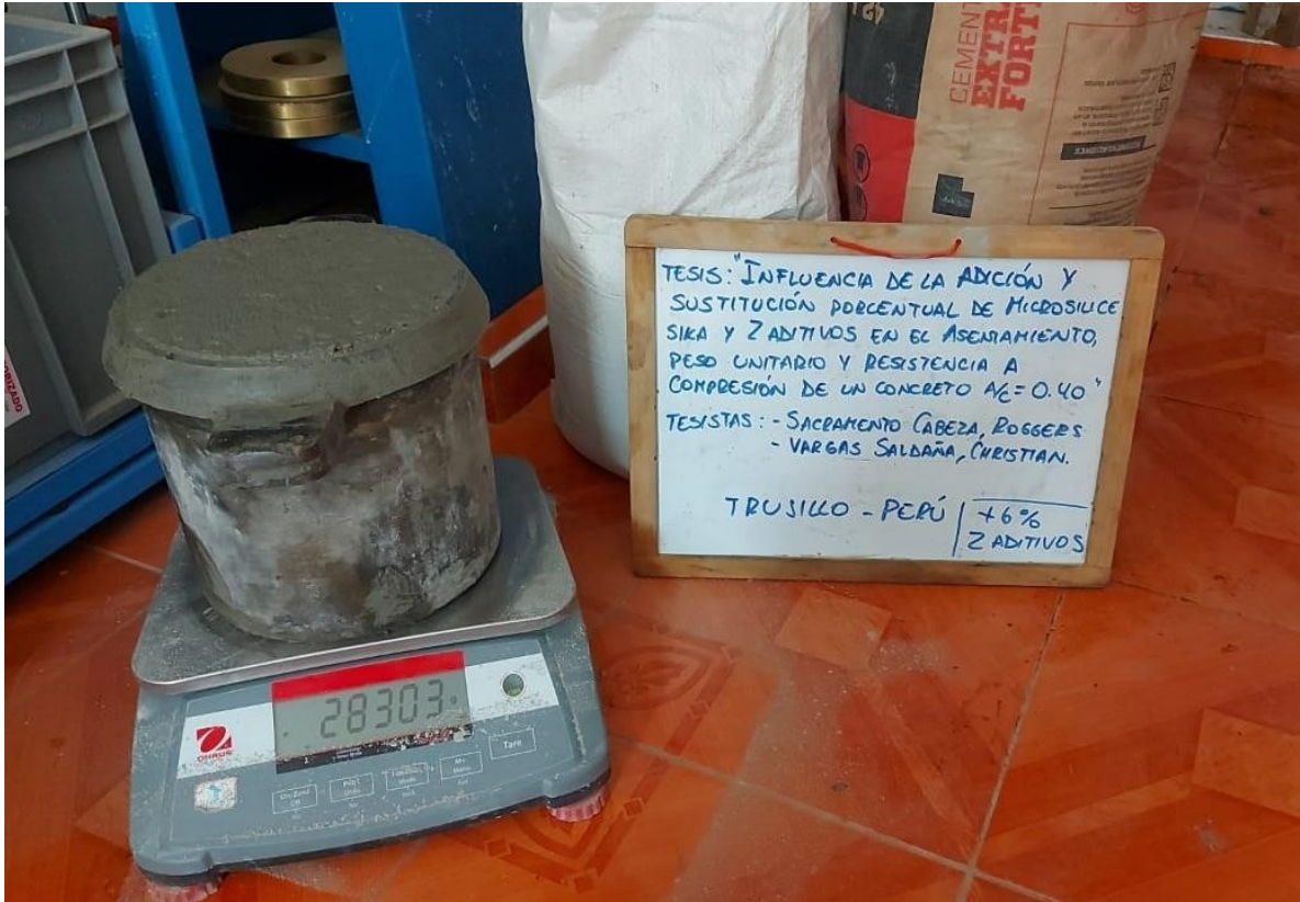
Figura 20. Ensayo de Peso Unitario para Concreto con adición de Z Silica al 6%.
