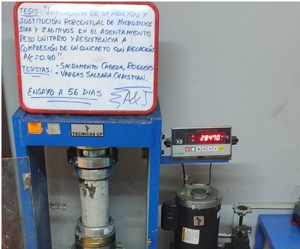
Figura 52. Ensayo de Resistencia a compresión a 56 días con sustitución de Sikafume al 6%
