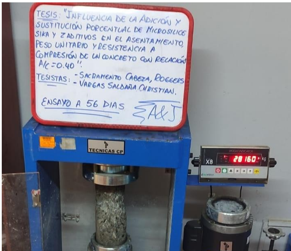
Figura 49. Ensayo de Resistencia a compresión a 56 días con adición de MicroSílca Z al 9%
