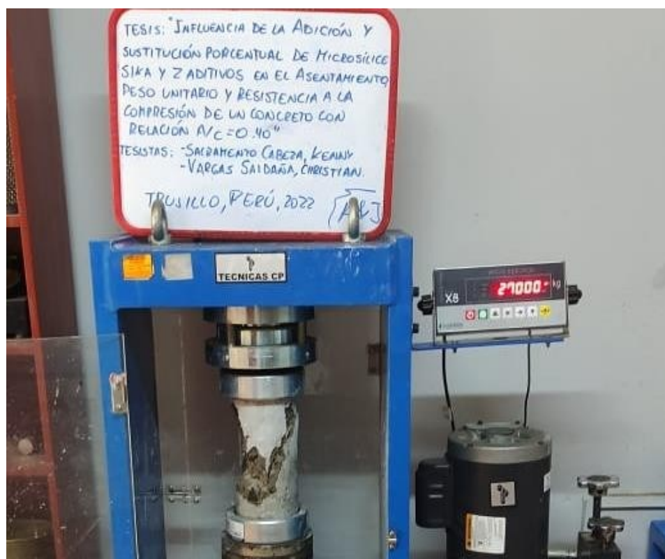
Figura 41. Ensayo de Resistencia a compresión a 28 días con sustitución de Sikafume al 6%
