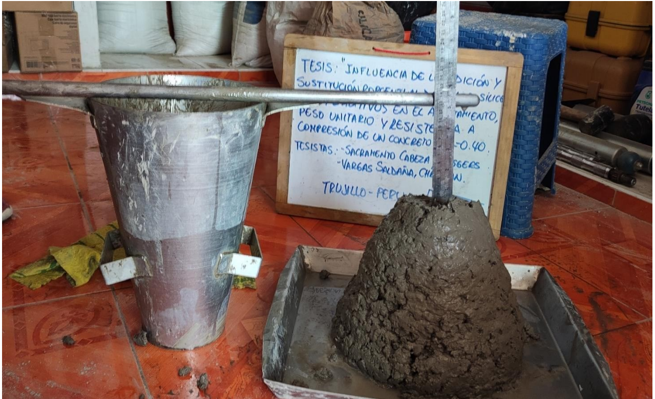
Figura 08. Ensayo de Asentamiento para Concreto Patrón.
