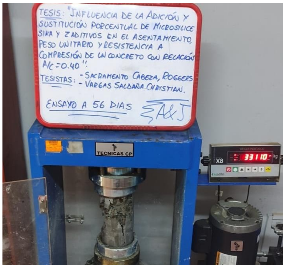
Figura 47. Ensayo de Resistencia a compresión a 56 días con adición de MicroSílica Z al 6%
