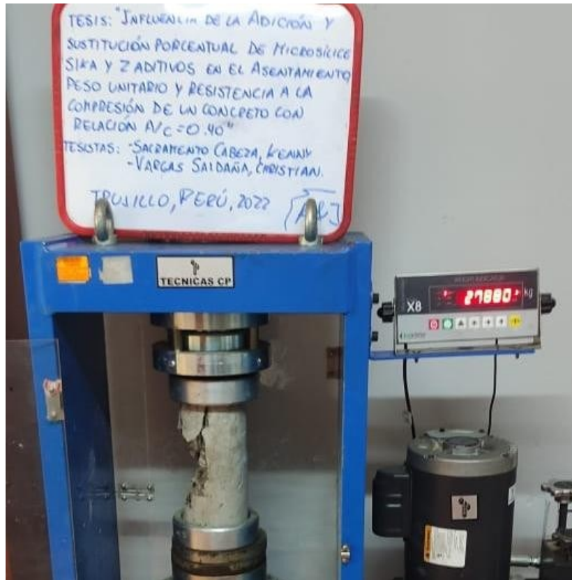
Figura 32. Ensayo de Resistencia a compresión, 28 días Concreto Patrón
