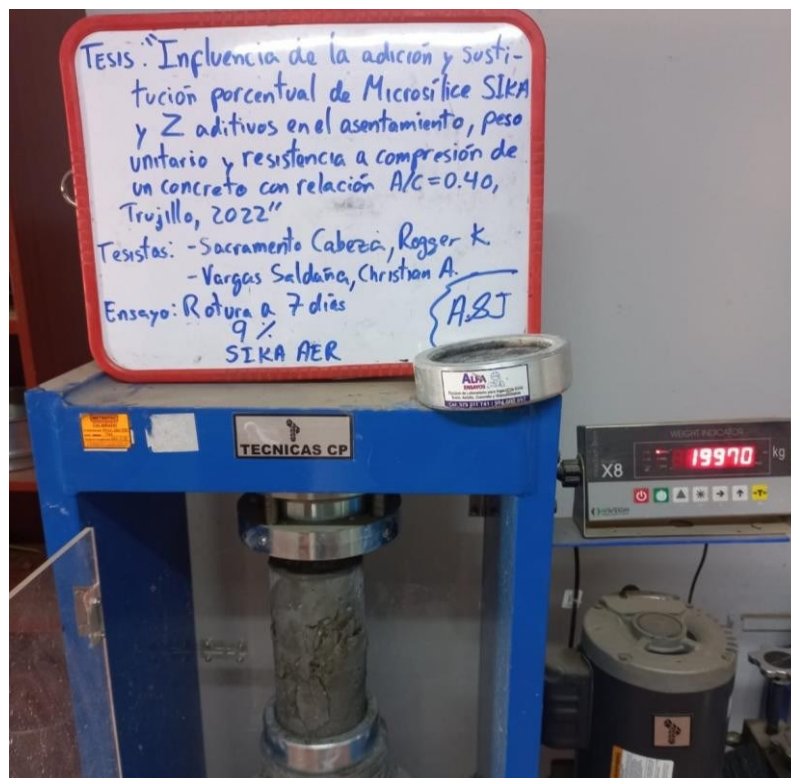
Figura 27. Ensayo de Resistencia a compresión a 07 días con adición de Sikafume al 9%
