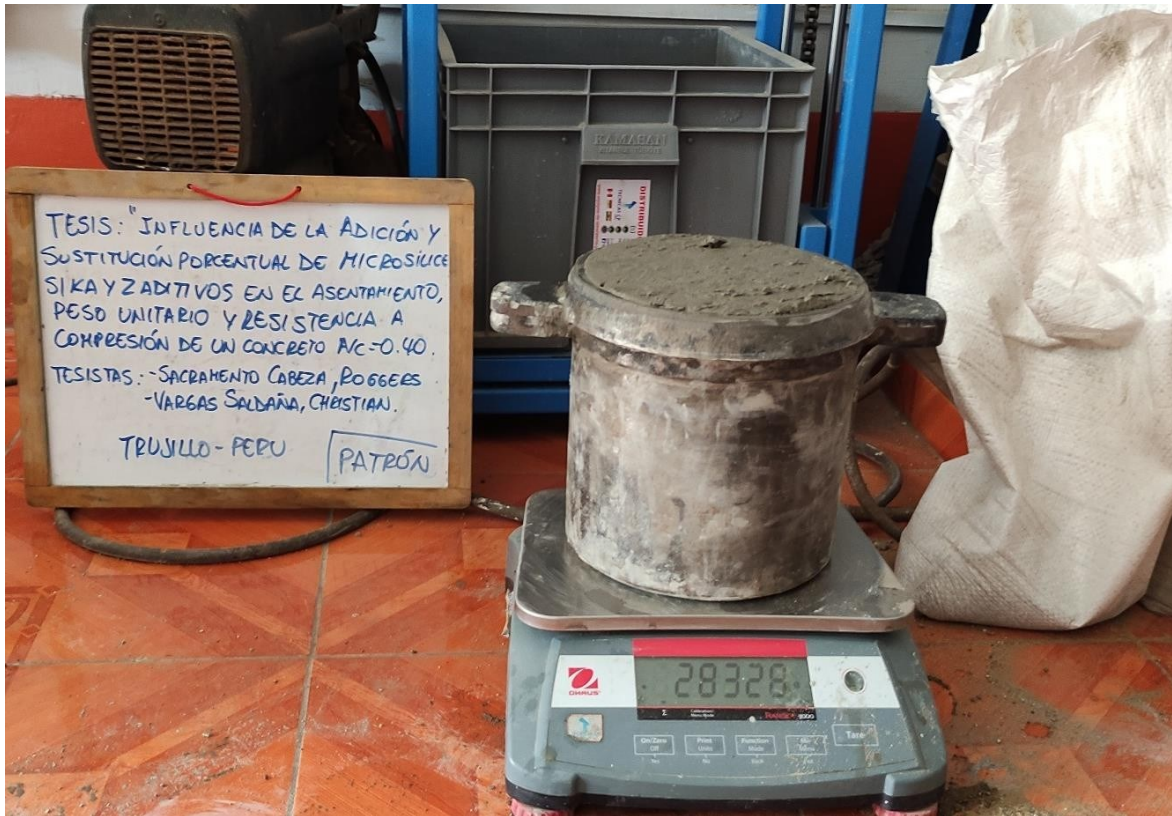
Figura 16. Ensayo de Peso Unitario para Concreto Patrón.
