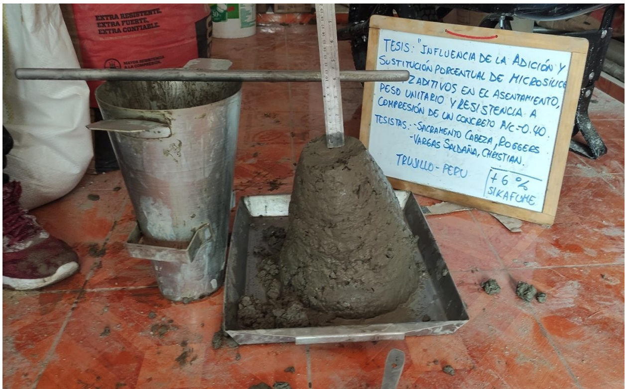
Figura 11. Ensayo de Asentamiento para Concreto con adición Sikafume al 6%
