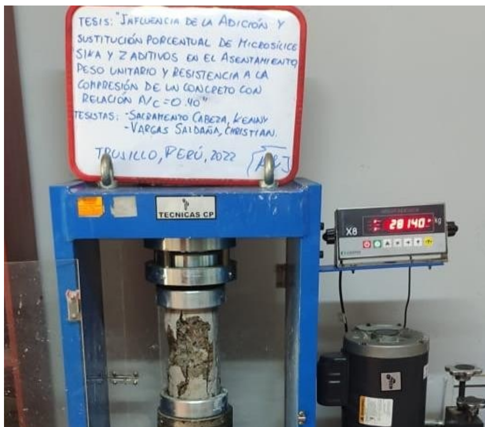
Figura 39. Ensayo de Resistencia a compresión a 28 días con sustitución de Sikafume al 3%
