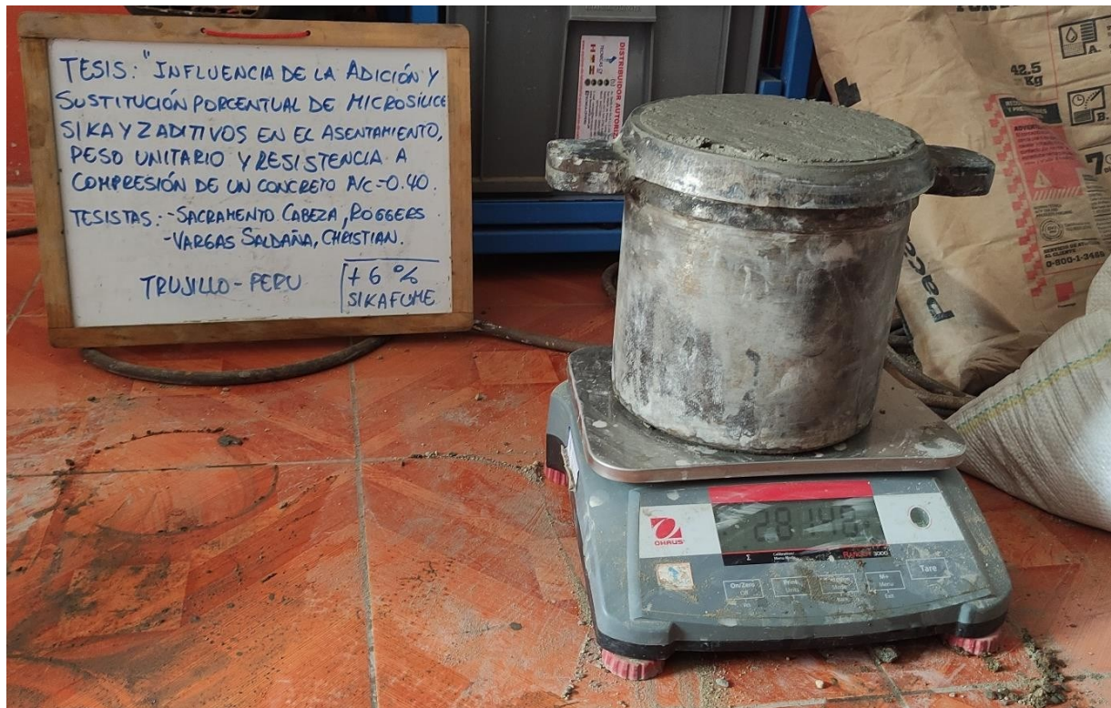
Figura 19. Ensayo de Peso Unitario para Concreto con adición de Sikafume al 6%.
