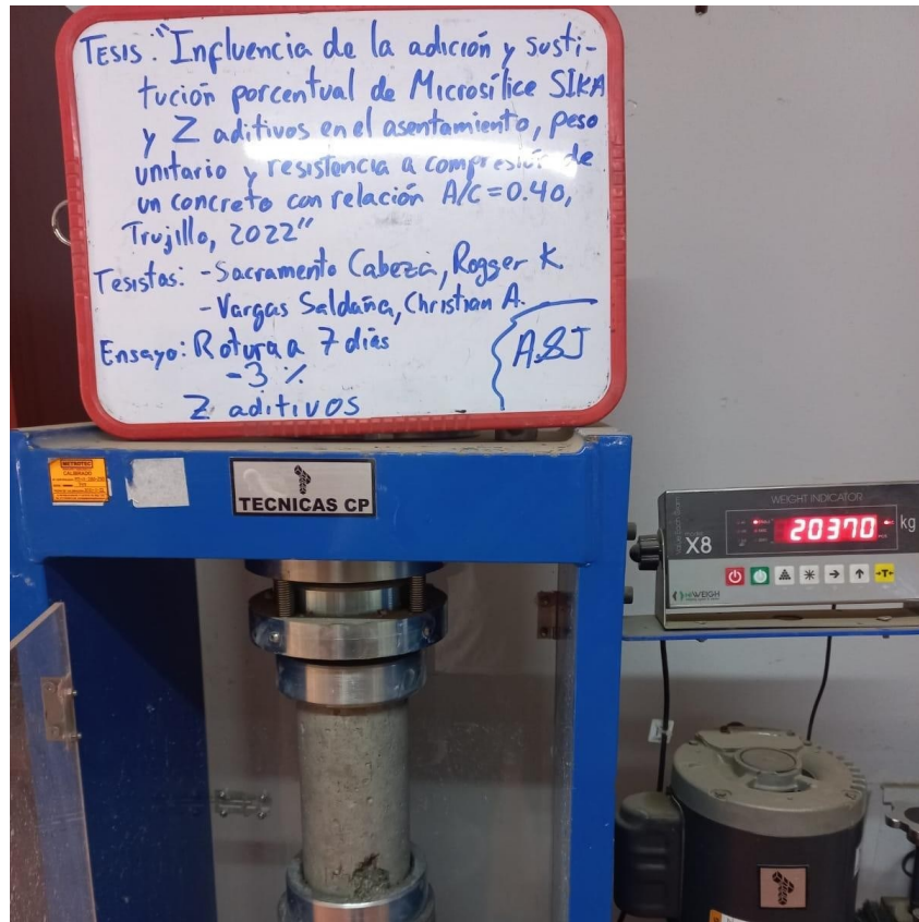
Figura 30. Ensayo de Resistencia a compresión, 07 días con sustitución de MicrosilicaZ al 3%
