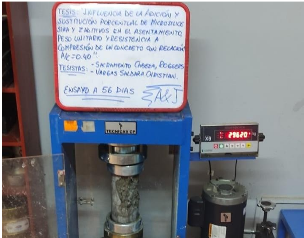
Figura 48. Ensayo de Resistencia a compresión a 56 días con adición de Sikafume al 9%
