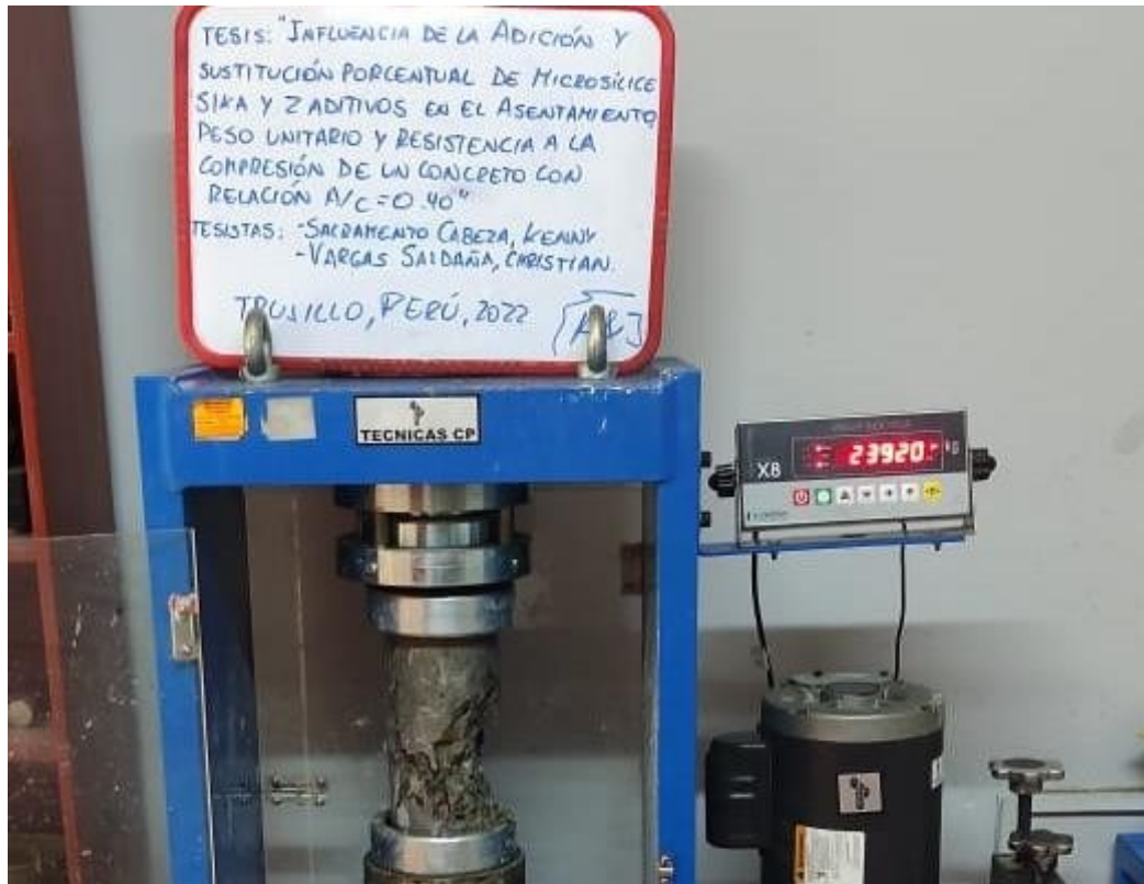
Figura 38. Ensayo de Resistencia a compresión a 28 días con adición de MicroSílca Z al 9%
