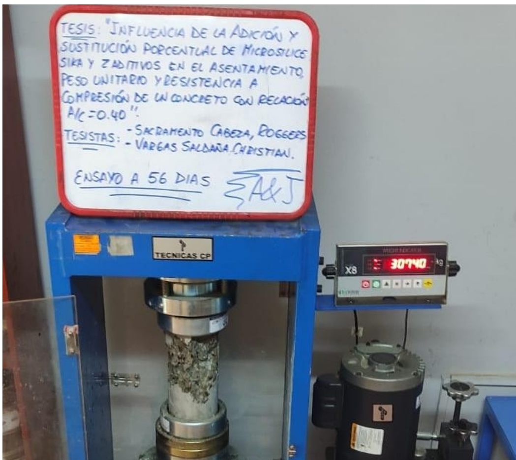
Figura 09. Ensayo de Resistencia a compresión del concreto.
