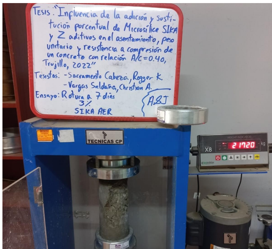
Figura 23. Ensayo de Resistencia a compresión a 07 días con adición de Sikafume al 3%.
