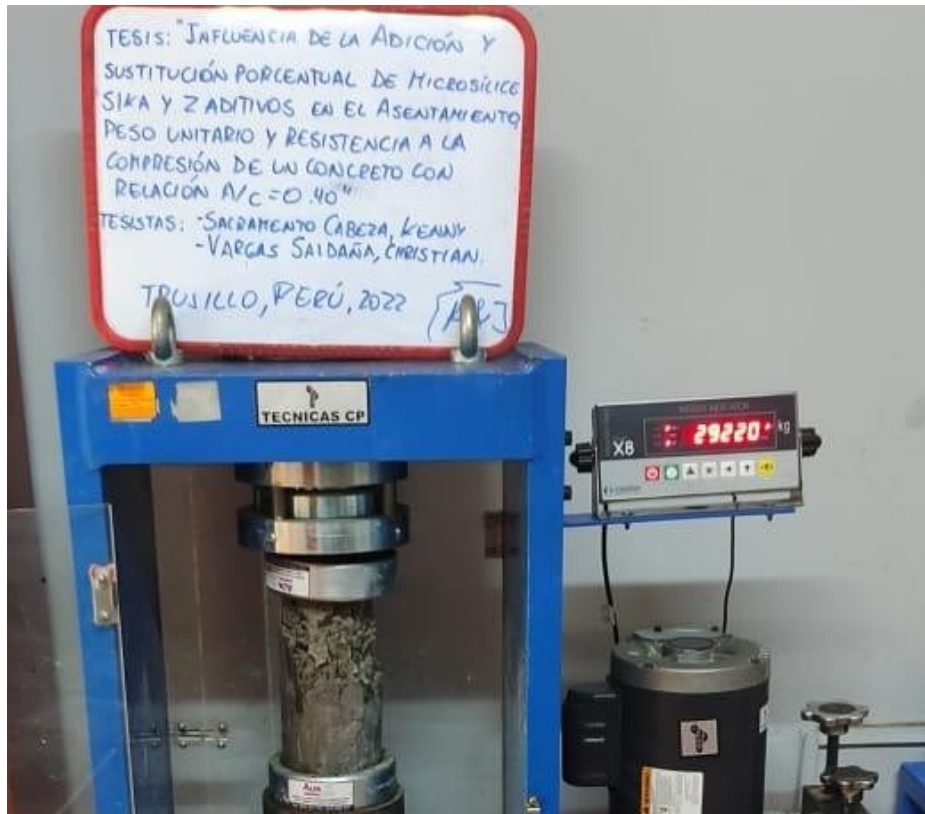
Figura 34. Ensayo de Resistencia a compresión a 28 días con adición de MicroSílica Z al 3%.
