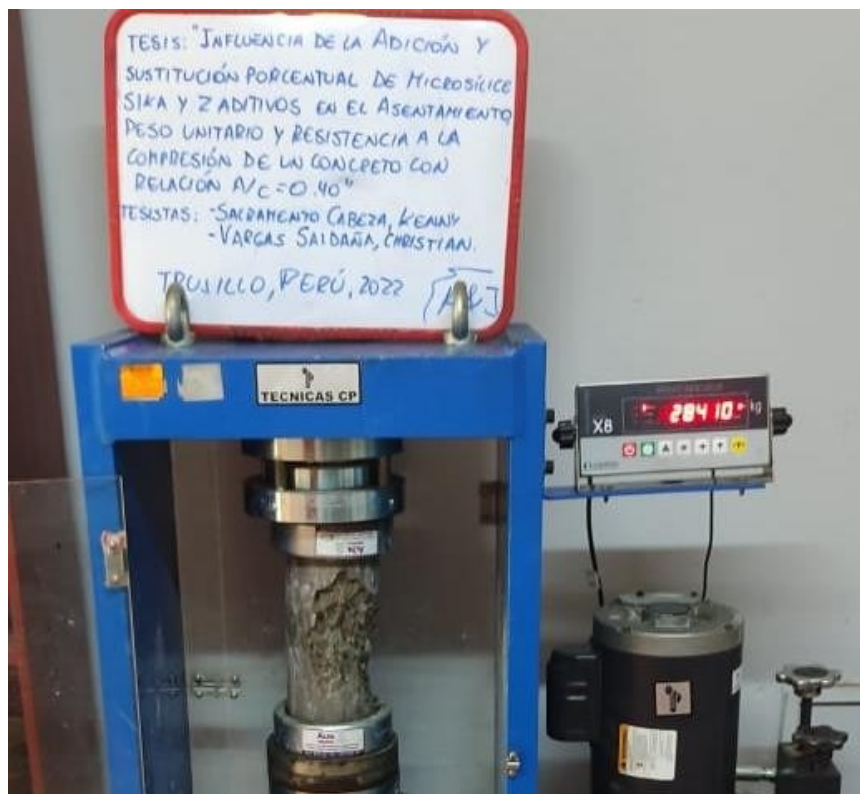
Figura 33. Ensayo de Resistencia a compresión a 28 días con adición de Sikafume al 3%
