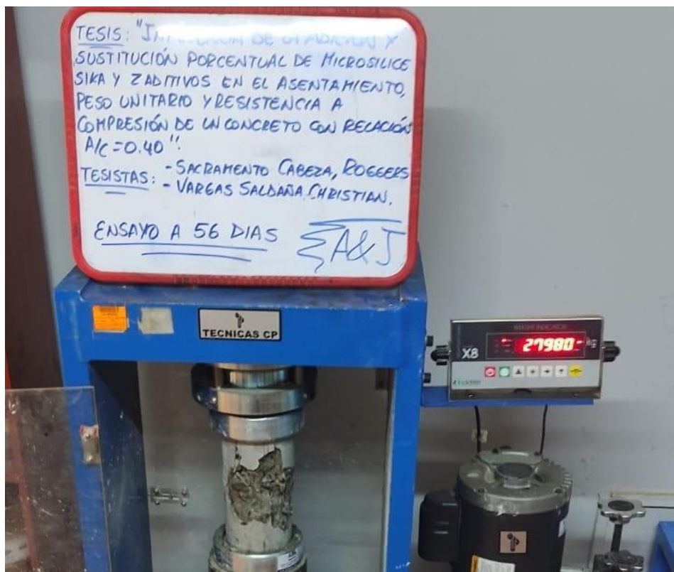
Figura 53. Ensayo de Resistencia a compresión, 56 días con sustitución de MicrosilicaZ al 6
