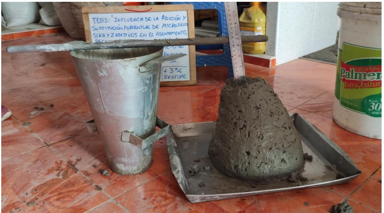
Figura 09. Ensayo de Asentamiento para Concreto con adición Sikafume al 3%
