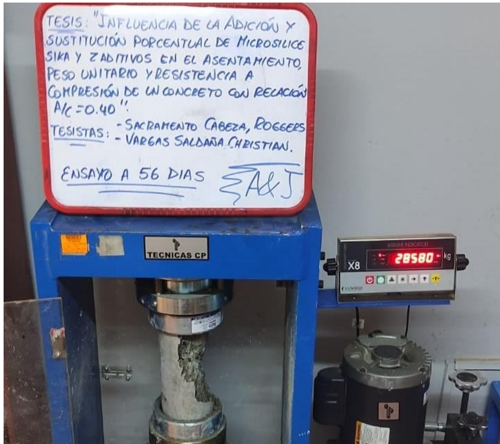
Figura 50. Ensayo de Resistencia a compresión a 56 días con sustitución de Sikafume al 3%
