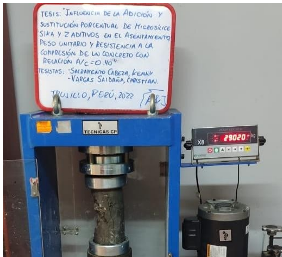
Figura 37. Ensayo de Resistencia a compresión a 28 días con adición de Sikafume al 9%
