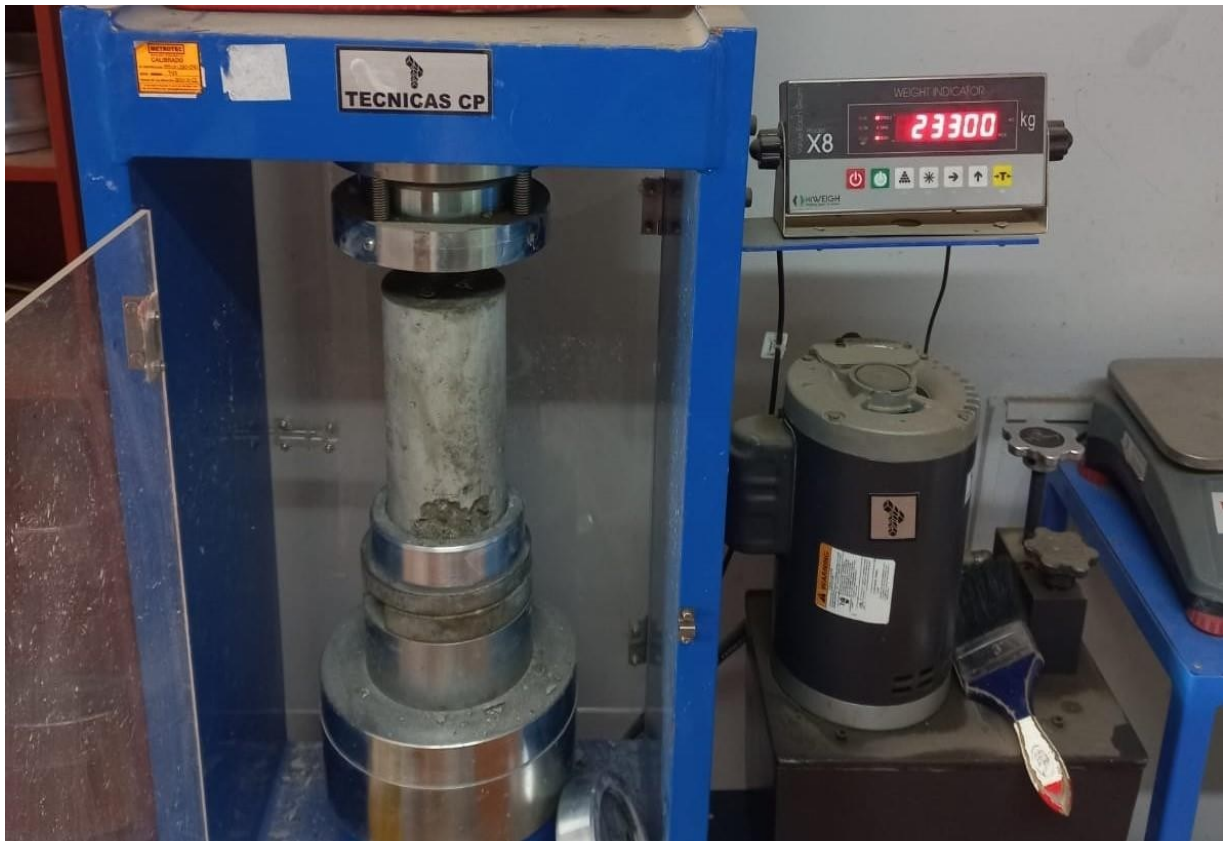
Figura 42. Ensayo de Resistencia a compresión, 28 días con sustitución de MicrosílicaZ al 6%
