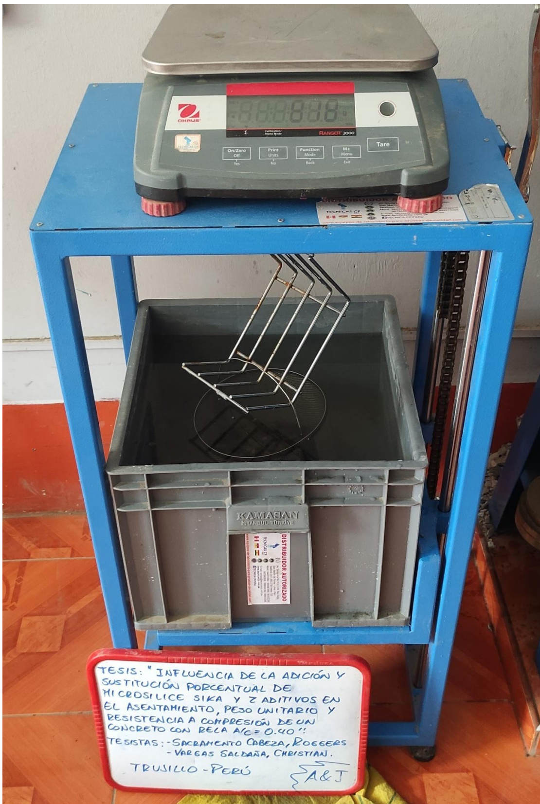
Figura 07. Ensayos de Peso Específico del agregado grueso, peso sumergido
