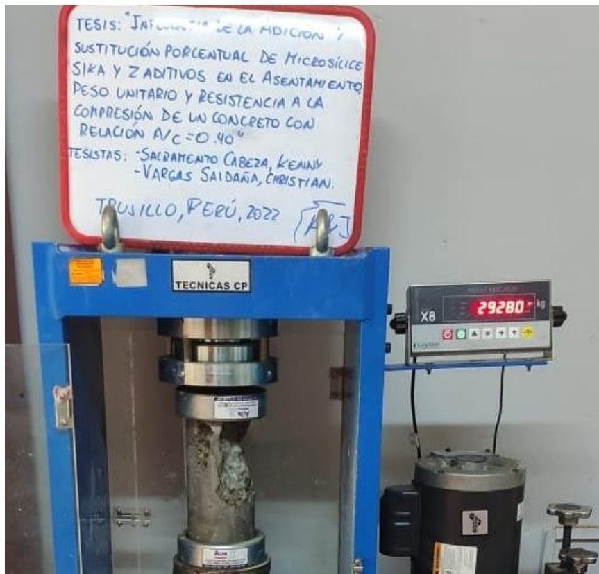
Figura 35. Ensayo de Resistencia a compresión a 28 días con adición de Sikafume al 6%
