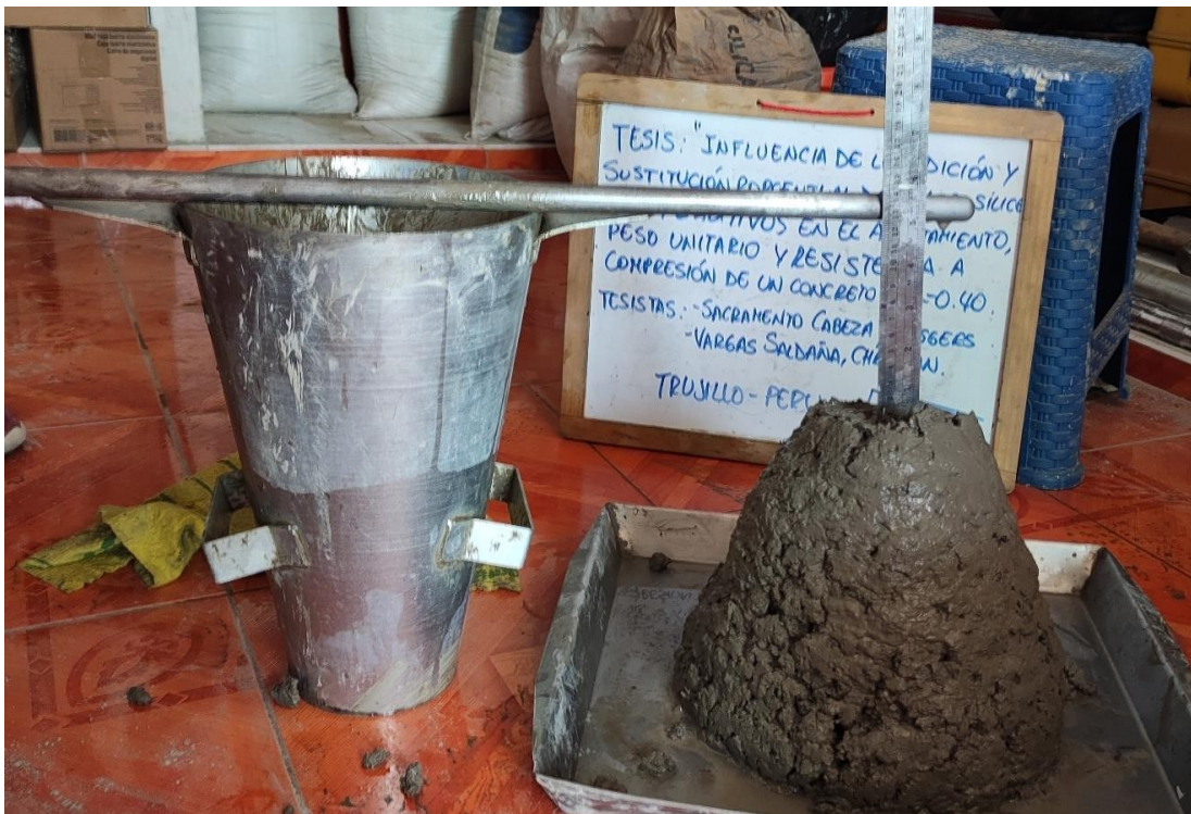
Figura 06. Ensayo de Asentamiento con cono de Abrams en mezcla patrón.
