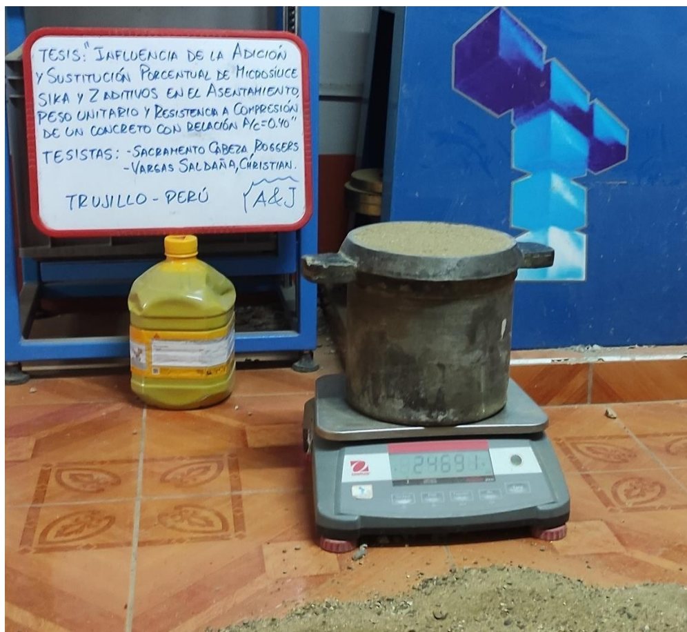
Figura 04. Ensayos de Peso Unitario Compactado del agregado fino.
