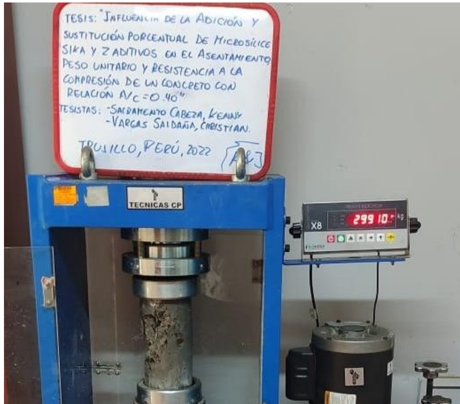
Figura 36. Ensayo de Resistencia a compresión a 28 días con adición de MicroSilica Z al 6%
