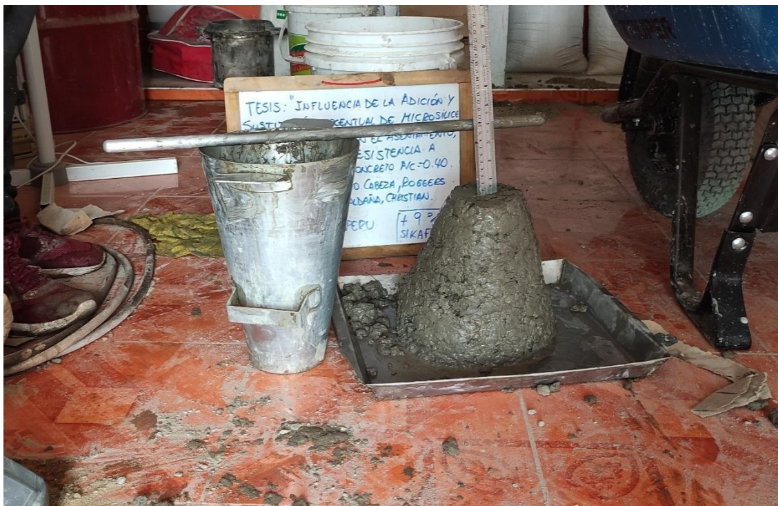
Figura 13. Ensayo de Asentamiento para Concreto con adición Sikafume al 9%
