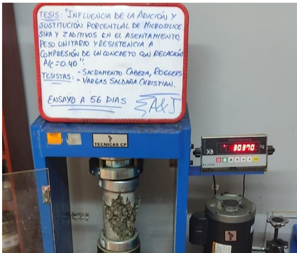
Figura 43. Ensayo de Resistencia a compresión, 56 días Concreto Patrón
