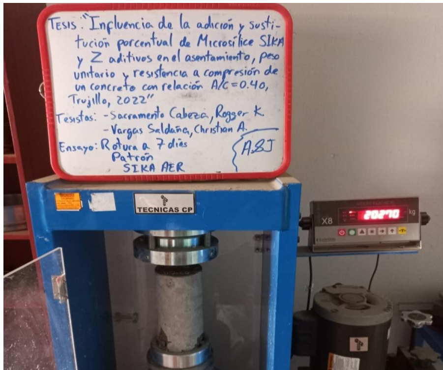
Figura 22. Ensayo de Resistencia a compresión a 07 días de concreto patrón
