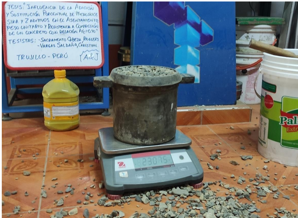
Figura 03. Ensayos de Peso Unitario Compactado del agregado grueso.
