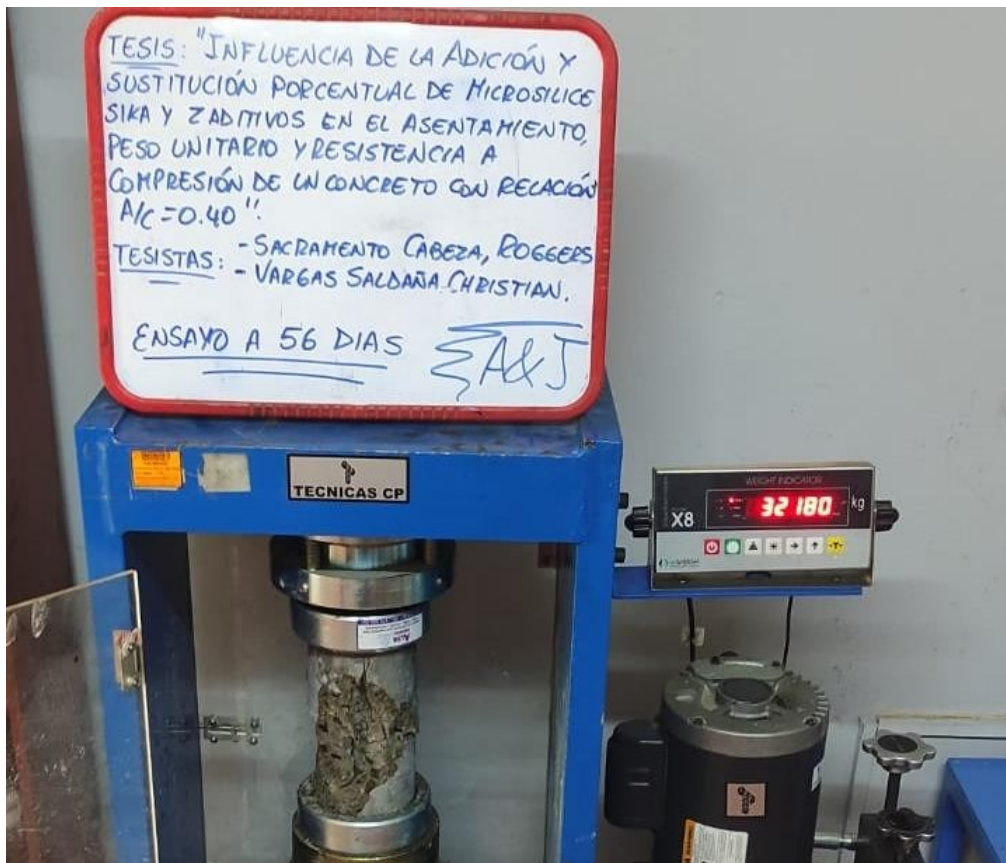
Figura 44. Ensayo de Resistencia a compresión a 56 días con adición de Sikafume al 3%
