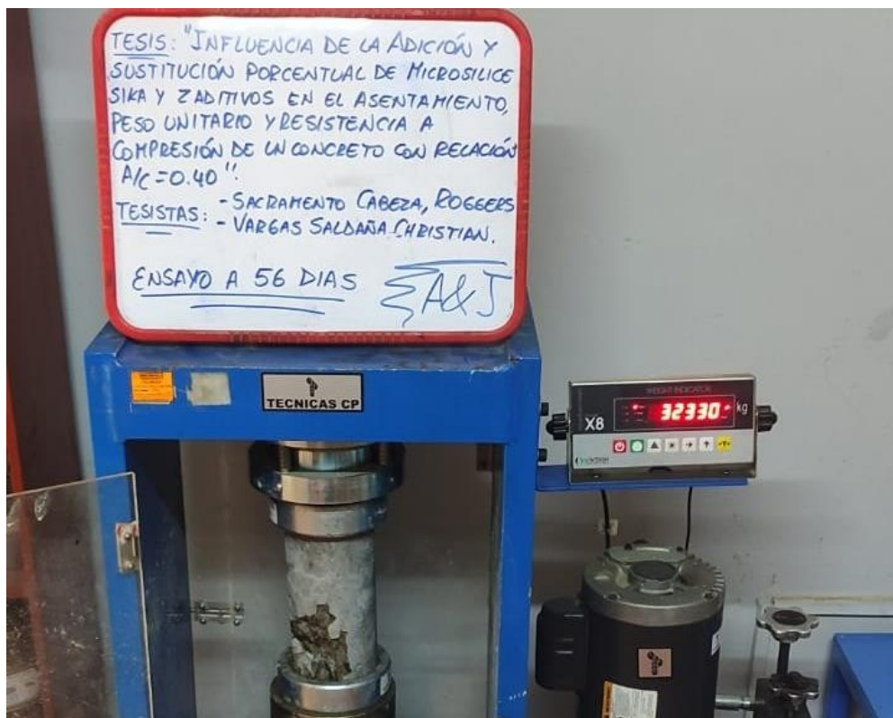
Figura 45. Ensayo de Resistencia a compresión a 56 días con adición de MicroSílca Z al 3%
