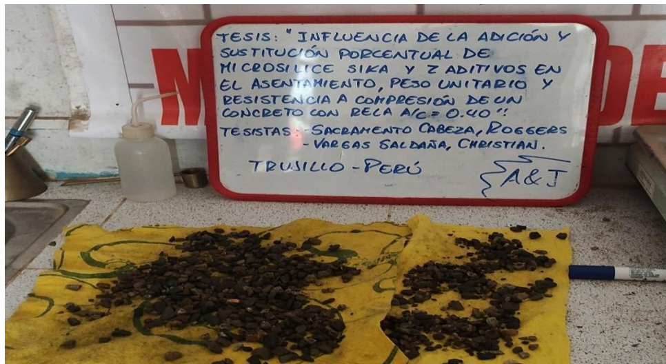
Figura 03. Ensayo de Peso Específico condición SSS para agregado grueso. 3.3.3.4. Peso Específico y Absorción del agregado fino.
