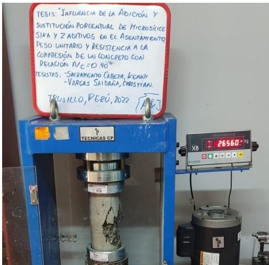
Figura 40. Ensayo de Resistencia a compresión, 28 días con sustitución de MicrosílicaZ al 3%
