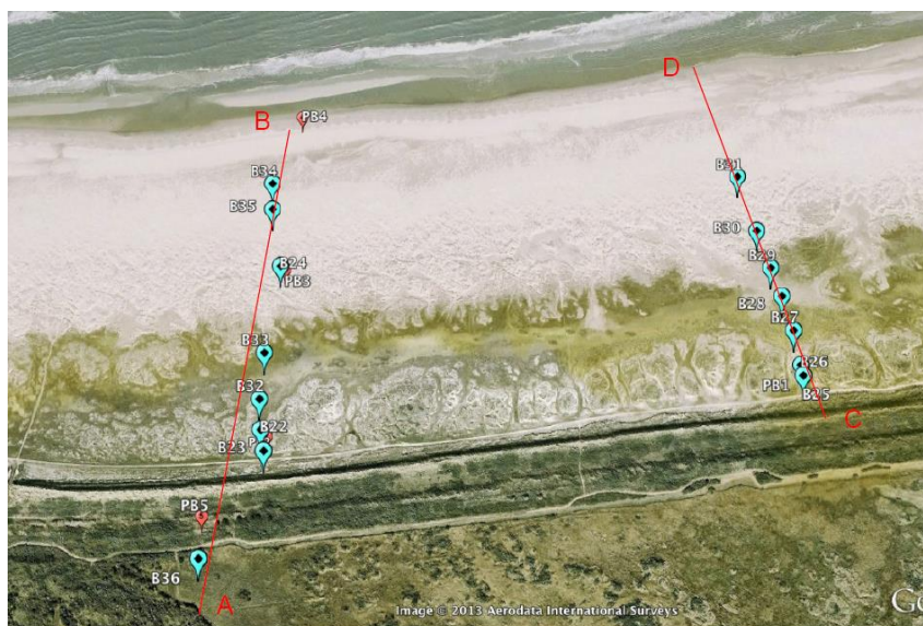
Figuur 6.2. Ligging van de meettraaien AB en CD, met de peilbuizen PB1-PB5 en een deel van de spiraalboorpunten B1-B36. De in november 2012 bemonsterde meetpunten staan in deze figuur.
