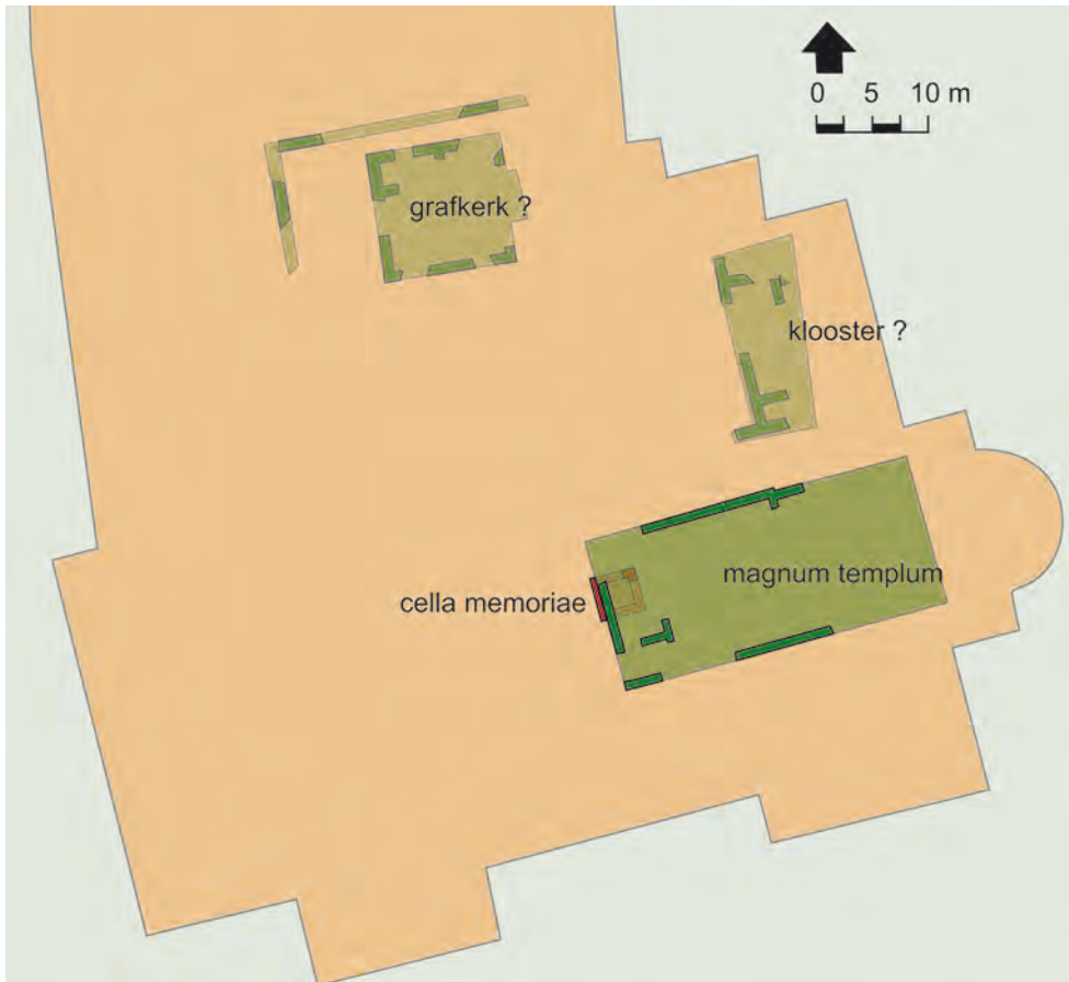
Afb. 9. Maastricht, St.-Servaaskerk. Contouren van het huidige kerkcomplex met de situering van het magnum templum (groen) en de cella memoriae (rood). Bovendien zijn enkele muur- en gebouwsporen uit dezelfde periode in lichter groen aangeduid (tekening: auteur).
