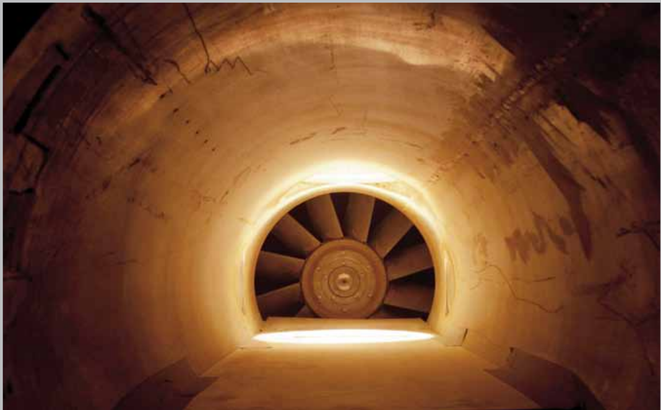
De windtunnel van de Deense Aarhus Universiteit, waarmee onderzoek werd gedaan naar het weggrollen van zand. Dankzij de drukkamer kan in de windtunnel de luchtdruk en chemische samenstelling van de Marsatmosfeer worden nagebootst. De foto kijkt langs de lengteas van de tunnel naar de propeller die de lucht door de tunnel circuleert. [Universiteit van Amsterdam]
