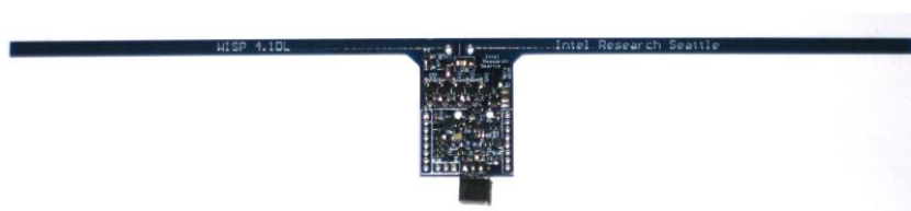
Figura 2.1. Etiqueta RFID UHF: WISP 5 [12]
