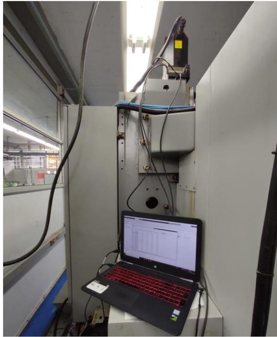
Durante cada proceso se toman señales de vibraciones por periodos de cinco segundos en diferentes instantes. Se realizó un total de ocho pruebas, mecanizando aluminio y acero 1045 con trayectorias tradicionales y trocoidales usando fresas de 8 mm, 10 mm y 12 mm.
