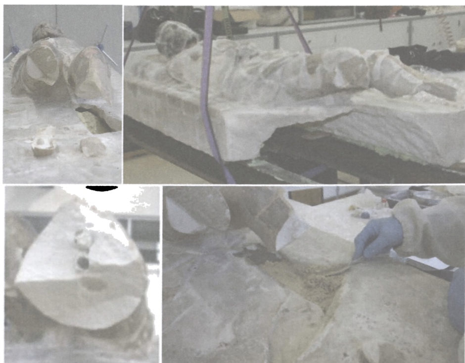
Fig. 104 - Tratamento da tampa e jacente: fragilidade da tampa sob as pernas (em cima, à esquerda e direita), múltiplas furações na perna esquerda (em baixo, à esquerda) e oclusão da lacuna sob as pernas (em baixo, à direita)
