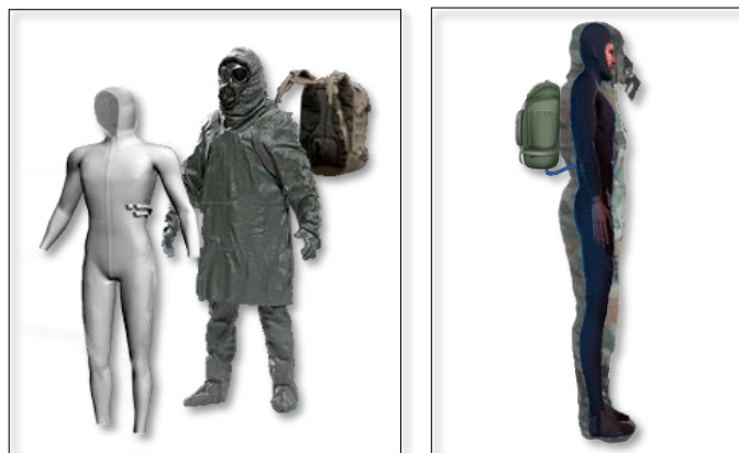
Figura 3.15 - Vista explodida dos constituintes do sistema. Primeiro o vestuário com arrefecimento líquido, seguidamente o fato de proteção e por fim uma mochila contendo o sistema do permutador de calor.
