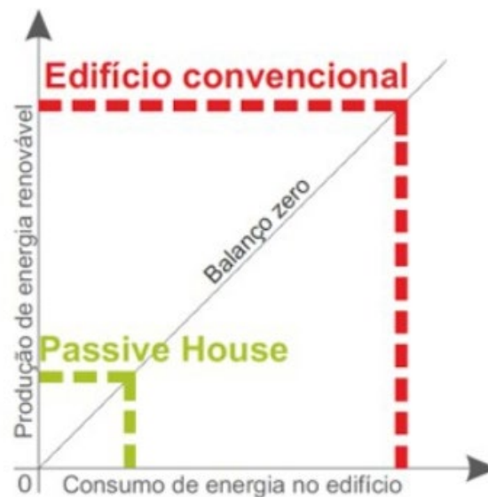
Figura 8: Balanço zero de Passive House e de um edifício convencional. Fonte: [29]
