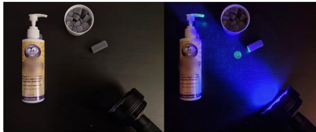
Fig.1 – Material para monitorização com gel indicador fluorescente e luz UV.
