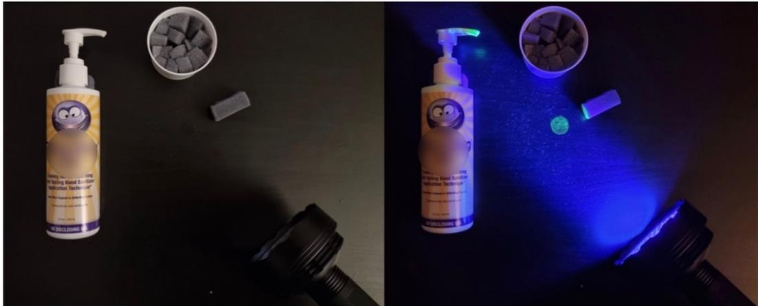
Figura 2: Método de avaliação da limpeza com gel marcador fluorescente e luz UV
