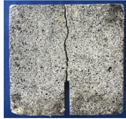
(d) Failure pattern for a_0/D = 0.3
