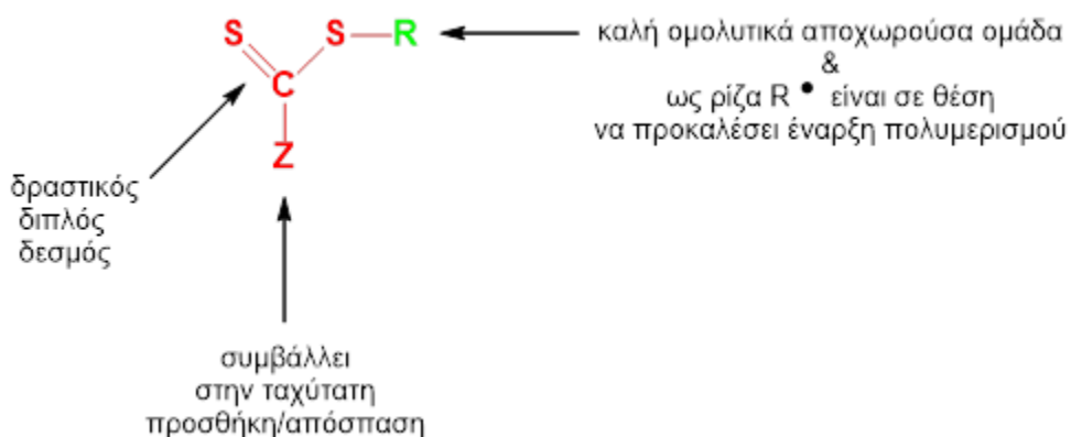
Σχήμα 4. Γενικά χαρακτηριστικά αντιδραστηρίων μεταφοράς.
