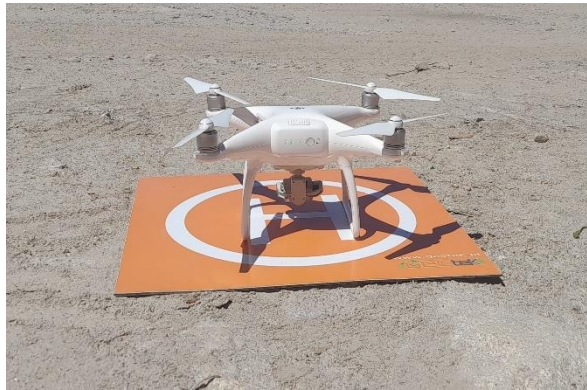
Figura 28 Drone DJI Phantom 4 com sensor CMOS.
