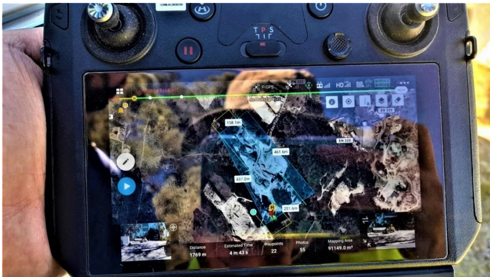
Figura 37 Interface da aplicação DJI Pilot no controlo remoto do drone DJI Matrice 300 RTK.
