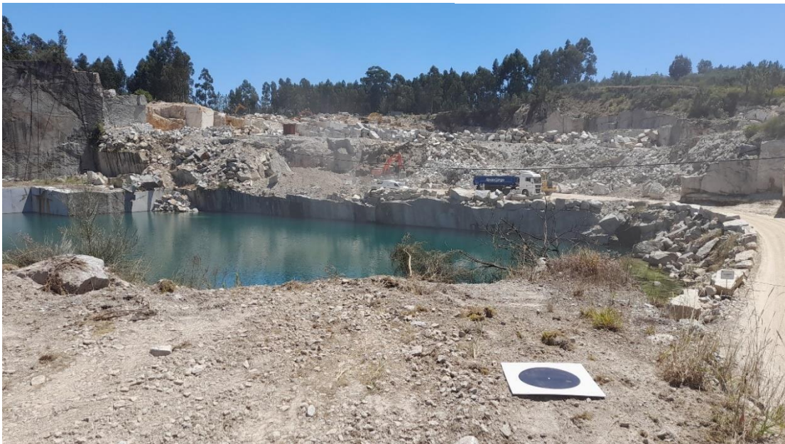
Figura 34 Colocação de um dos cinco pontos de controlo.
