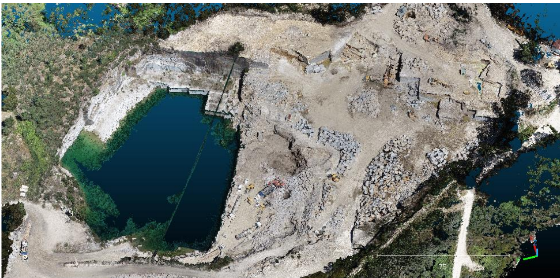
Figura 42 Nuvem de pontos gerada a partir de imagens obtidas por fotogrametria aérea no dia 1 de julho de 2022, visualizada no CloudCompare.
