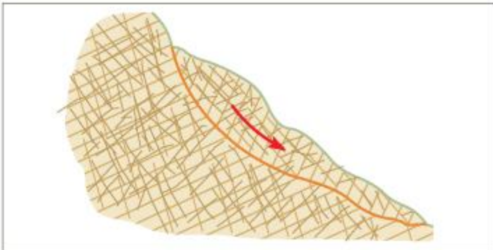
Figura 17 Rotura circular num afloramento rochoso com grande grau de fraturação. Retirado de González de Vallejo et al. (2002).
