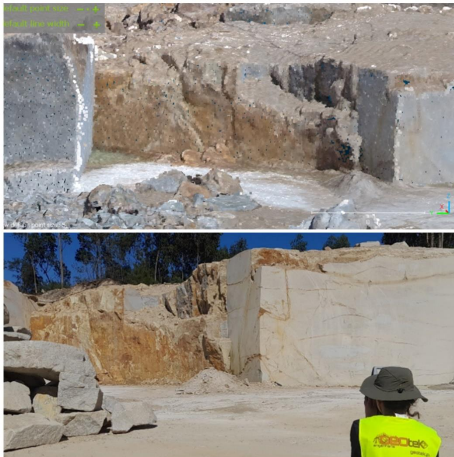
Figura 60 Zona de fraturação intensa do granito representada na nuvem de pontos (em cima) e no campo (em baixo).
