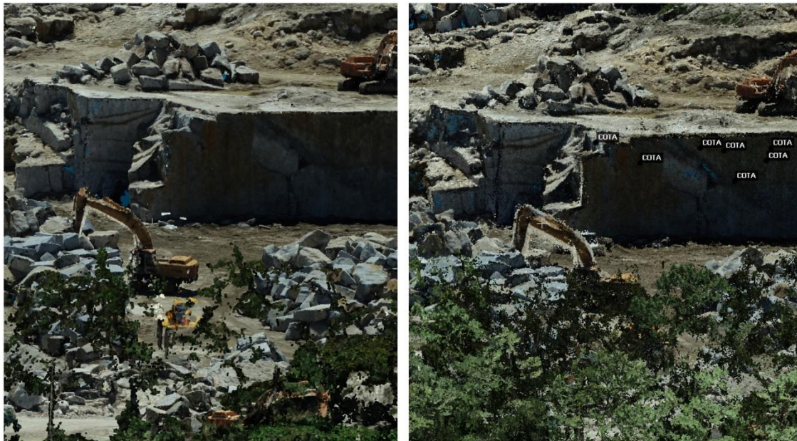
Figura 41 Comparação entre a qualidade da nuvem de pontos gerada no AGISOFT Metashape (à esquerda) e no 3Dsurvey (à direita) à escala 1:240.
