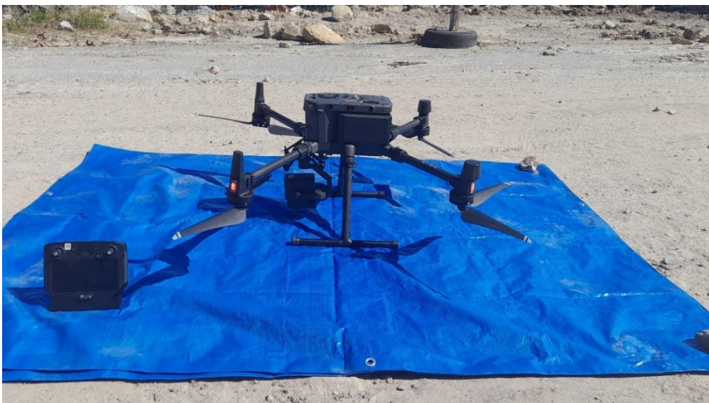
Figura 36 Drone DJI Matrice 300 RTK e comando remoto do drone, no canto esquerdo.
