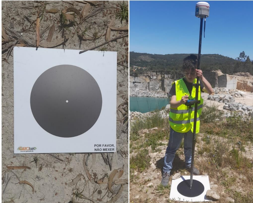
Figura 30 Colocação dos pontos de controlo no campo (à esquerda) e medição das coordenadas no ponto de controlo com a antena GPS (à direita).
