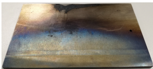
Figura 3.3: Acumulação de borracha numa das lâminas
