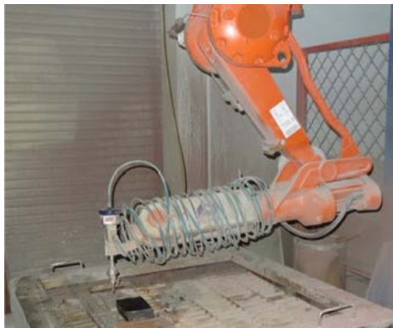
Figura 2.22: Máquina de corte a jato [25]
