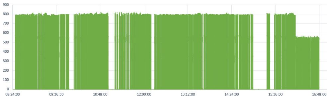
Figura 6.2: Medição da força de corte da máquina 02 com mudança de operador
