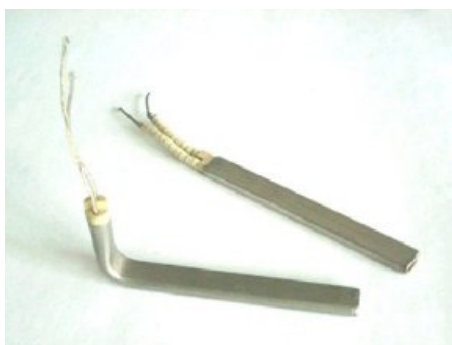
Figura 3.11: Resistências de contacto ROTFIL ® utilizadas [35]
