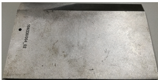
Figura 3.13: Lâmina em estado novo
