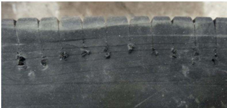
Figura 2.23: Estudo sobre a profundidade de corte a jato [25]
