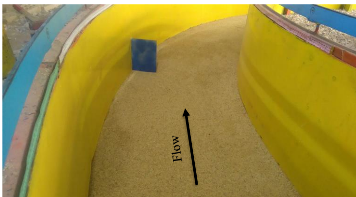
Fig. 3- Spur dike Structure شکل ۳- نمایی از سازه آبشکن نفوذ ناپذیر
