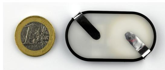
**Abbildung 2:** Die verwendete Inertialsensoreinheit mit 1-Euro-Münze als Größenvergleich.
