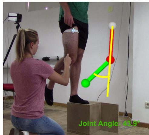
**Abbildung 5:** Der Proband führt die aktive Winkelreproduktion aus. Gleichzeitig wird das virtuelle Skelett gezeigt. Zur Kontrolle der Genauigkeit wird der Gelenkwinkel von der Testleitung mit einem Goniometer gemessen.
