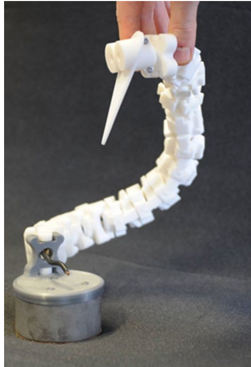
Abbildung 8: Erstes vereinfachtes Hardwaremodell des Eulenhalses
