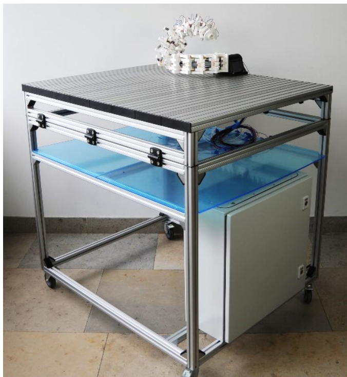
Abbildung 22: Aufgebauter Prototyp mit Arbeitswagen und Schaltschrank
