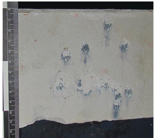
Рис. 6. Пошкодження білої силікатної цегли, спричинені рикошетом 5,6 мм свинцевих куль
