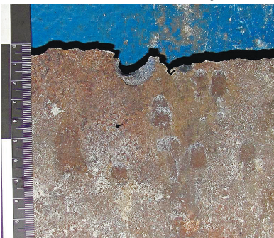
Рис. 5. Сліди рикошету на поверхні металевій плиті, спричинені влучанням 5,6 мм свинцевих куль
