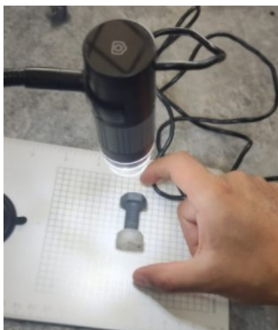
Figura 2. - Utilización del microscopio para tomar fotografías de los pernos.
