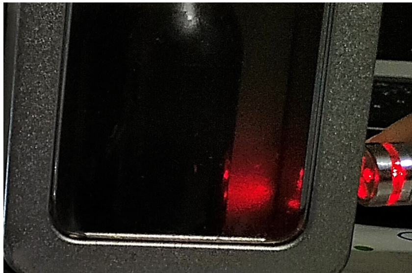
Figura 12. Diagnóstico para la detección del líquido de frenos en un automóvil. Elaboración propia de los autores.
