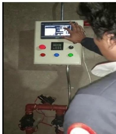
**Figura 5.4.**Programación de tiempos de riego
