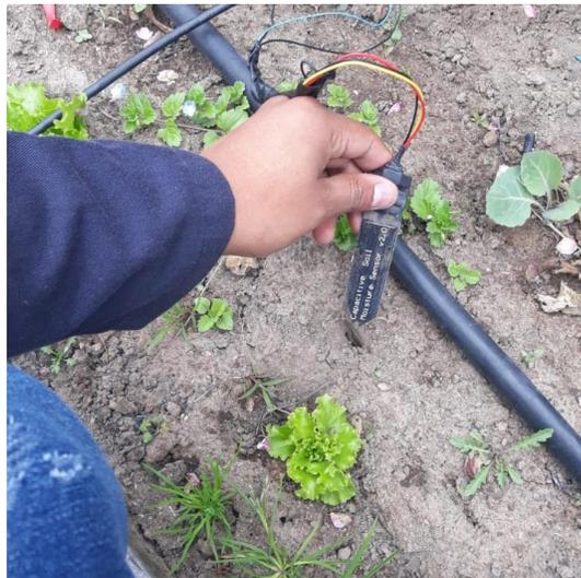
**Figura 4.7.** Colocación de sensores para su calibración
