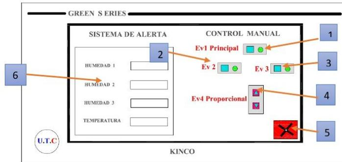
Al presionar en la pantalla la opción CONTROL MANUAL se despliega una ventana de operación, la cual detallan cada uno de los elementos a controlar, con sus respectivas opciones de encendido y apagado.
