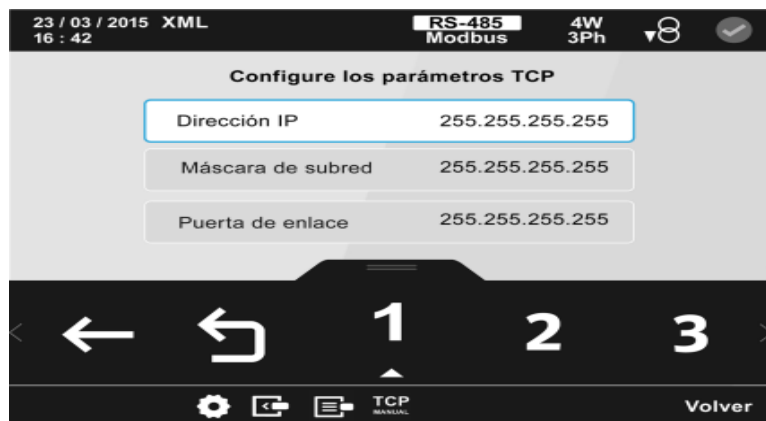
Figura 4.14: Pantalla de configuración de los parámetros TCP Manual.
