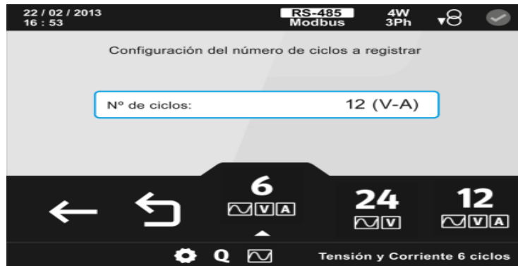
Figura 4.11: Pantalla de configuración del nº de ciclos a registrar.
