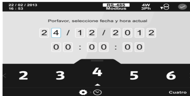
Figura 4.4: Pantalla de configuración de fecha y hora.
