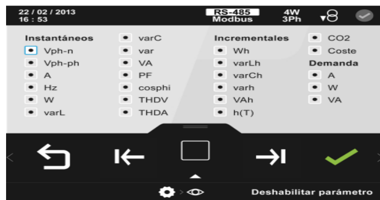
Figura 4.12: Pantalla de configuración de la visualización de variables.
