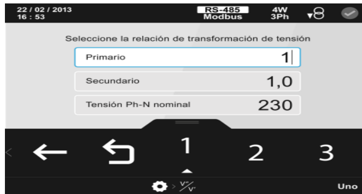
Figura 4.8: Pantalla de configuración de la relación de los transformadores de tensión.
