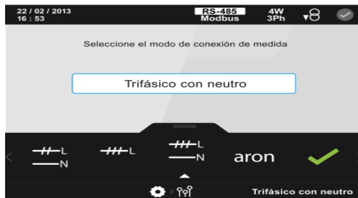
Figura 4.7: Pantalla de configuración del modo de configuración de la medida.
