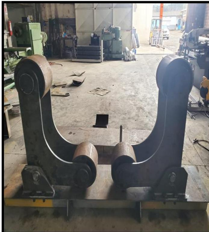
Imagen 3.26: Rodillos de volteo armados
