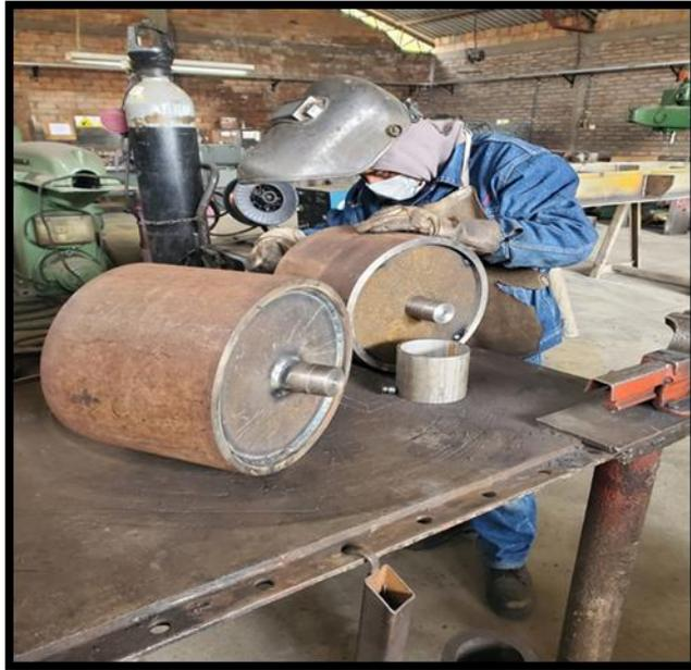
Imagen 3. 17: Soldadura de rodillos
