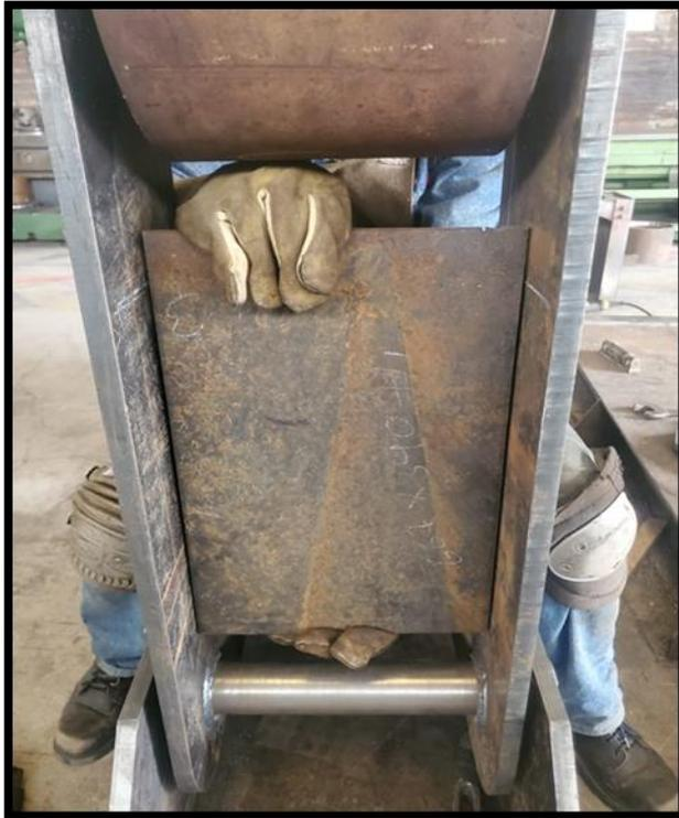
Imagen 3. 21: Colocación de alma de la estructura
