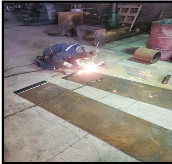
Imagen 3.11: Soldadura de planchas.
