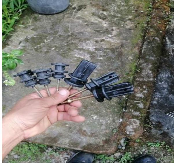
Figura 20: Aisladores del alambre para el cerco eléctrico.
