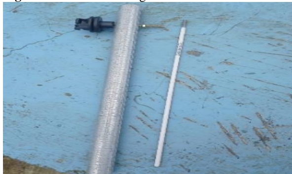
Figura 18: Poste de tubo galvanizado.
