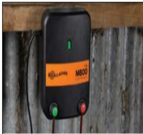
Figura 5: Energizadores enchufados de 110V.
