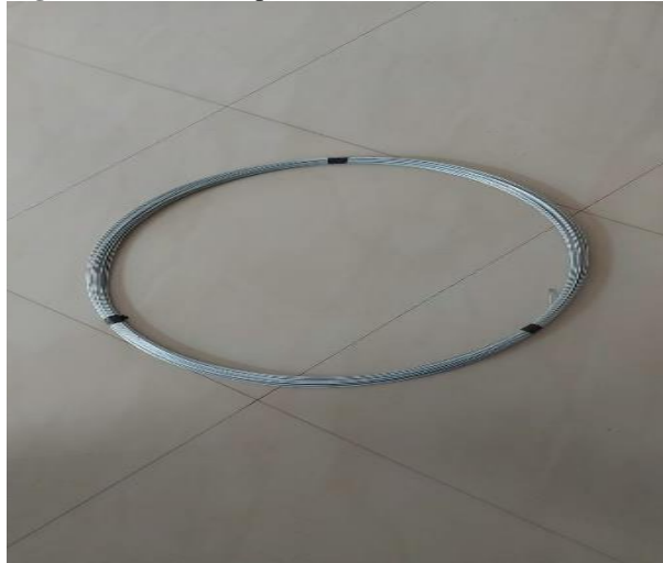
Figura 21: Alambre para el cerco eléctrico calibre #12.
