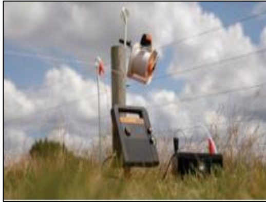
Figura 6: Energizador a baterías.
