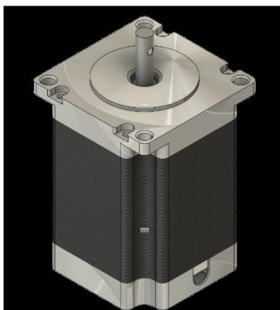
Figura A.10. Modelación del Motor Nemas 23
