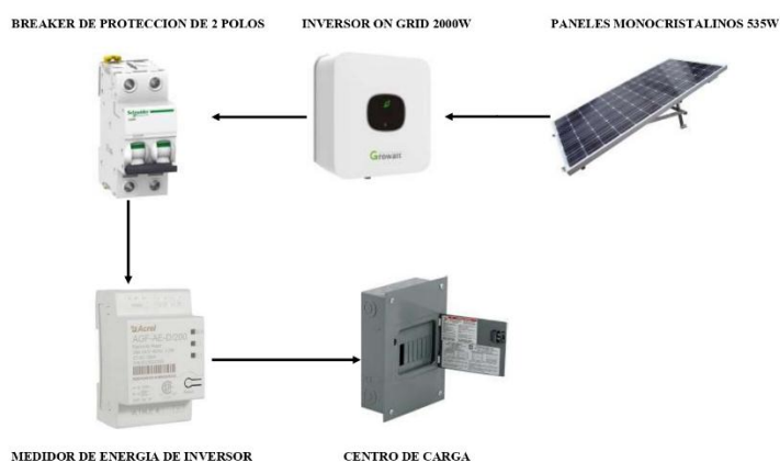
Figura 21. Diagrama de conexiones del sistema de generación
