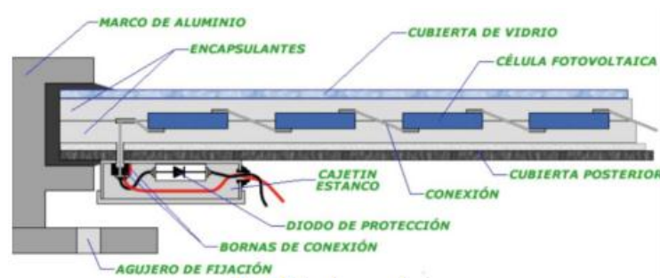
Figura 13. Partes de un panel solar.
