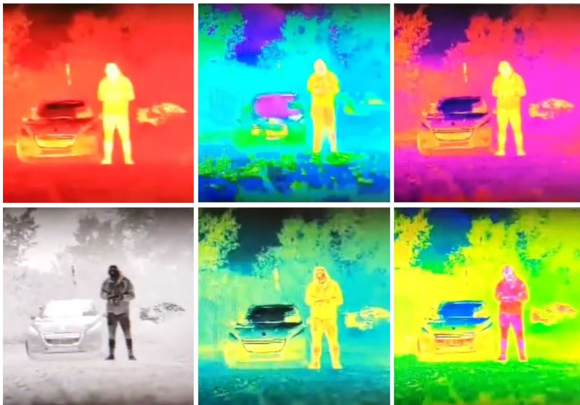
Figur 13 Ulike fargepaletter for å synliggjøre termiske data. Paletten velges etter oppdrag, værforhold og pilotens erfaring (skjermdump fra Test 1 «Streaming test»).
