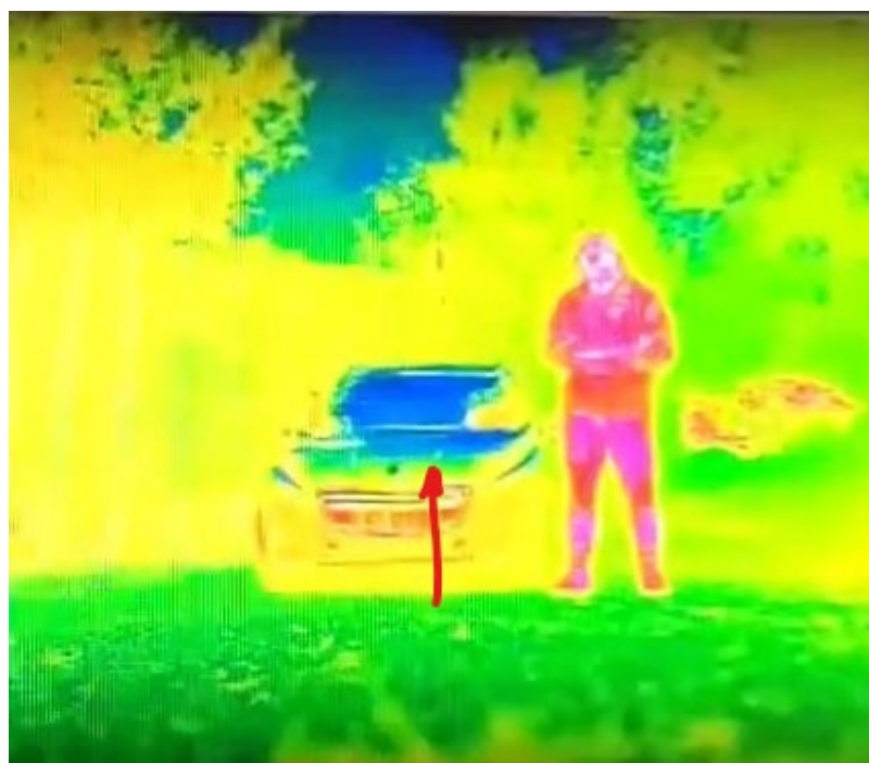
Figur 12 Droneoperatøren viser frem sensitiviteten av dronens termiske sensor ved å vise et handavtrykk (rød pil) på bilens karosseri (skjermdump fra Test 1 «Streaming test»).
