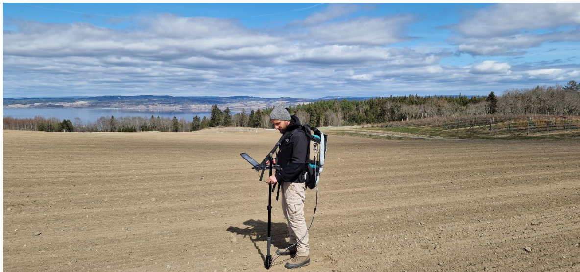
Figur 14. Jordreflektansmålinger med ASD Fieldspec spektrofotometer utstyrt med tungsten halogen lyskilde.
