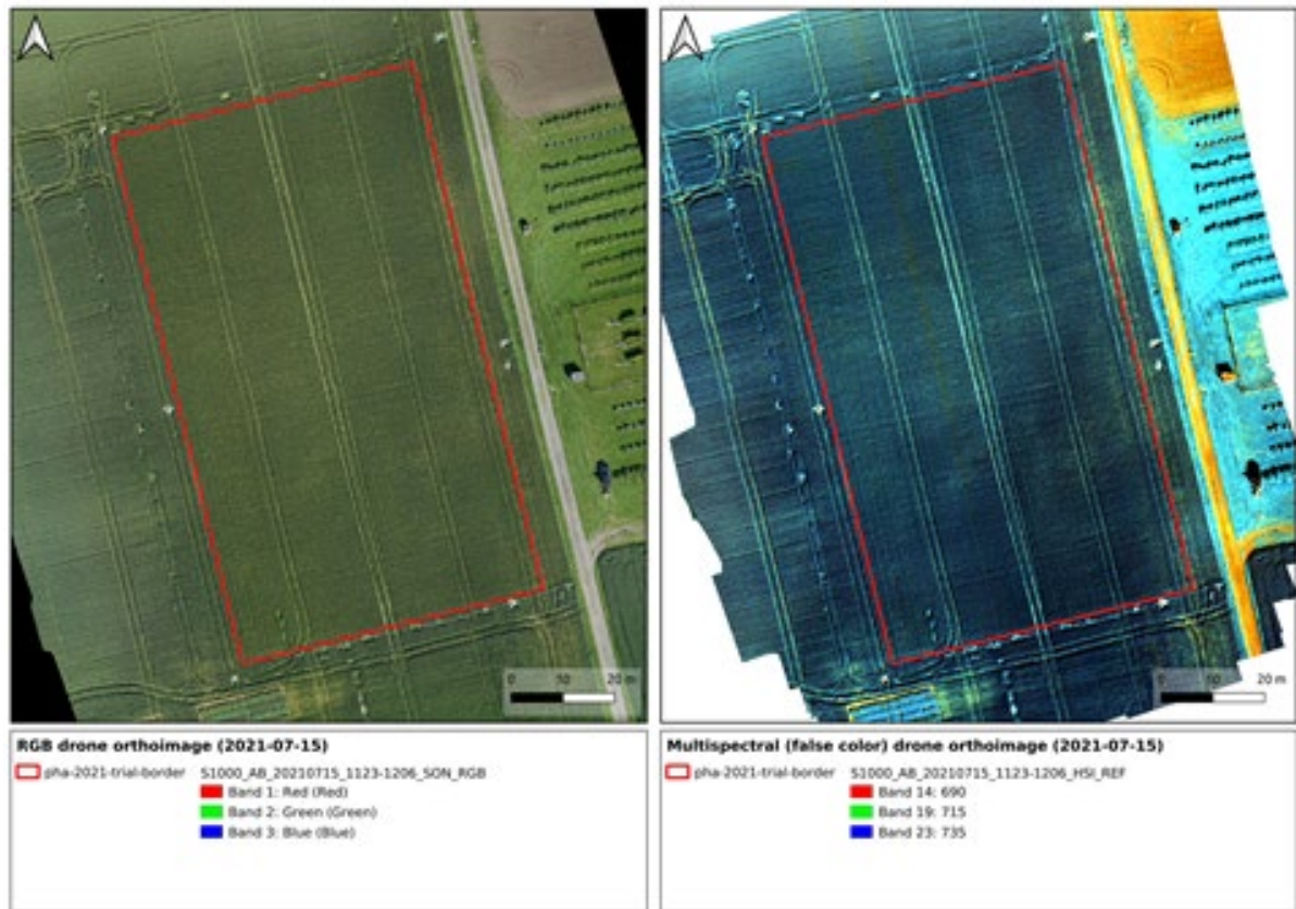
Figur 18. Sony a5100 RGB ortofoto (til venstre) og Rikola HSI multispektralt ortofoto (til høyre) av presisjonshektaren ved aksskyting (15. juli 2021). Romlig oppløsning på henholdsvis 0,01 m og 0,04 m per piksel. Det multispektrale ortofotoet er sammensatt av tre red-edge bølgebånd som tydeliggjør variasjonen i klorofyllinnhold sammenlignet med det standard RGB ortofotoet.
