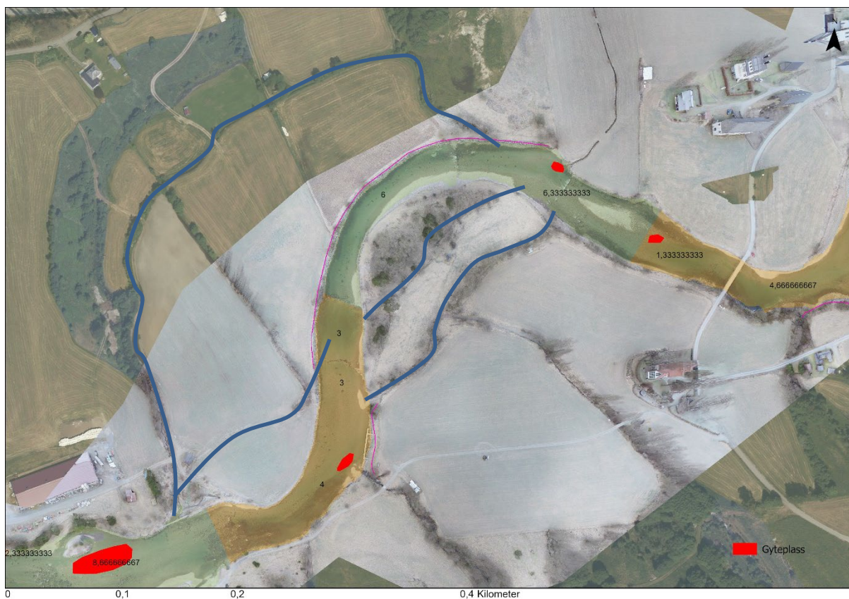
Figur 41: Tiltaksområde 5. 3 terskler modifiseres med lavvannsrenne og utlegg av blokker (Pri 1). Sideløp 1 på ytterst nordsiden har 1 m fall på 700 m lengde, den er vannførende allerede i dag og trenger finjusteringer (Pri 2). Sideløp 2 på nordsiden nærmere elven har 0.6 m fall på 200 m og kan utformes som potensielt bra sjørrethabitat (Pri 1). Sideløp på sørvestsiden midt på grusøre har 0.5 m fall på 150 m lengde og er lett å få til (Pri 1). Sideløp på sørvestsiden ytterst på grusøren har 0.7 m fall på 200 m lengde og får ekstra vann fra tilløpsbekk (Pri 1). Kantvegetasjon (Pri 1).
