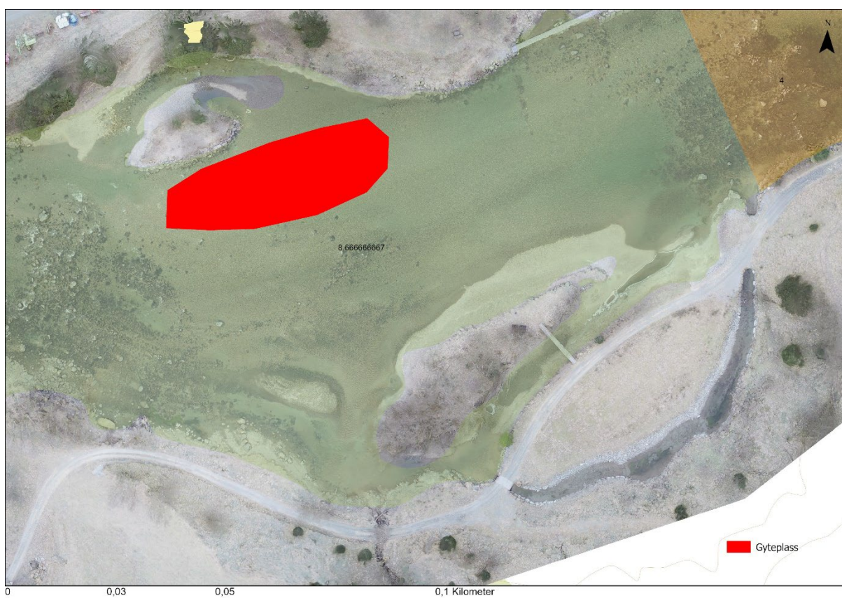
Figur 43: Tiltaksområde 6. Sideløp på sørsiden av elven. Bør vurderes å variere i bredde, smalere partier med stryk og gyteplass (Pri 2). Ripping av hovedløpet utenfor gyteplassen (Pri 2). Kantvegetasjon (Pri 1).
