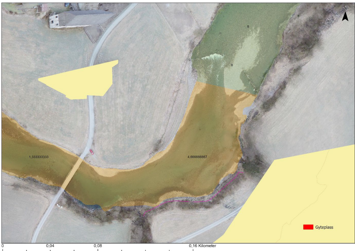
Figur 37: Tiltaksområde 4. Terskelbasseng er fylt opp med masser som gjør strekningen nesten fluvialt. Anbefales lavvannsrenne på østsiden av terskelen (Pri 2). Vurdering av erosjonssikring med
