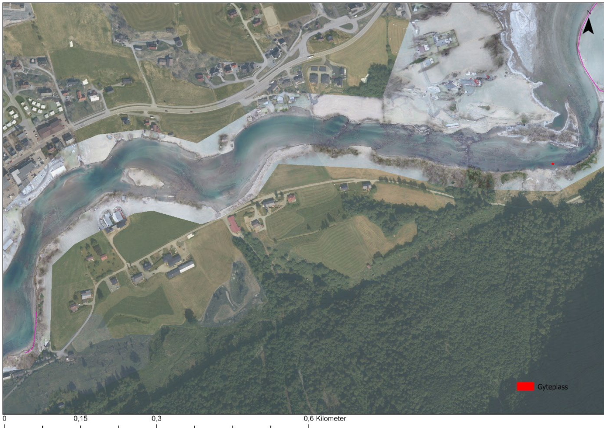
Figur 47: Tiltaksområde 10. Flekkvis gyting rundt blokkene ved øyen fremmes med utlegg av flere blokker, steingrupper og gytegrus (Pri 1). I brakkvannsonen fra ca. gyteplassen anbefales utlegg av gytegrus og optimalisering av tersklene for å forbedre gyteforholdene (Pri 1). Kantvegetasjon (Pri 2).
