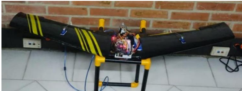
Figura 9: Prototipo de ala Zagi pa evasión de obstaculos Recuperado de (Aviles Correa & Garzón Bernal, 2021)
