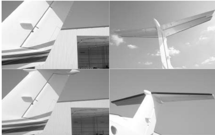
Figura 1.3 Timón de dirección y de profundidad de la aeronave King Air Series 200 posicionados y con la prueba de chequeo realizada según las instrucciones del fabricante [26]
