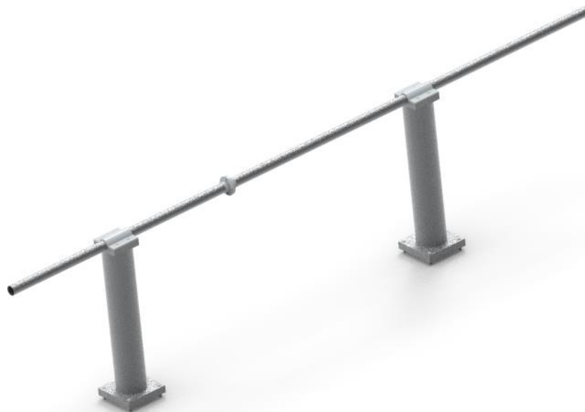
Figura 10 Renderizado para un tubo de choque supersónico con soportes fijos al suelo. Fuente: Autores. Software Solid Edge
