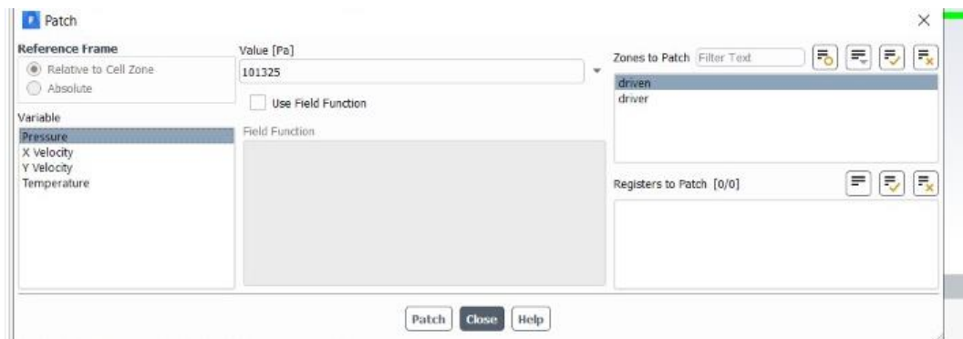
Figura 16 Definición de presión para la sección driven . Fuente: Autores. Software Ansys.
