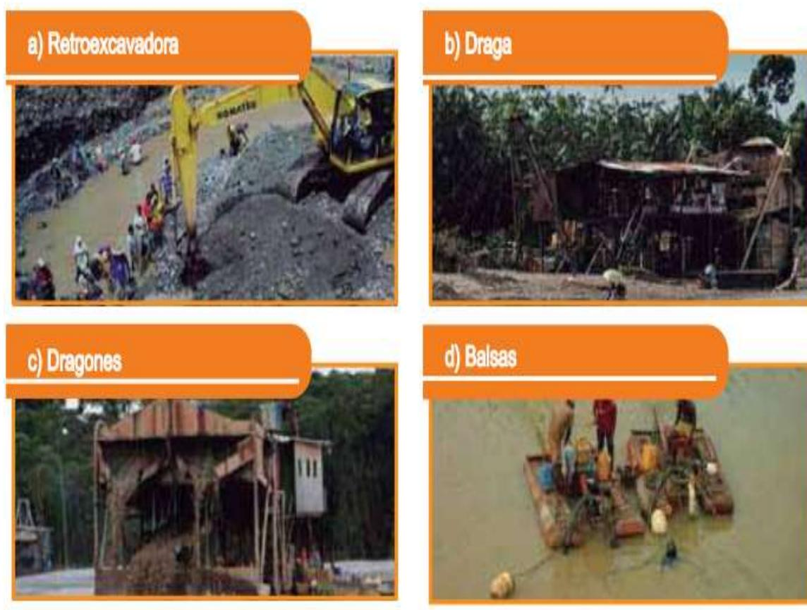
*Ilustración 5 Maquinaria usada para la explotación de aluvión*
