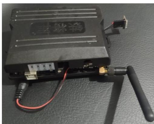
Figura 24. Dispositivo emisor adaptado en una carcasa plástica. Fuente: Autor.
