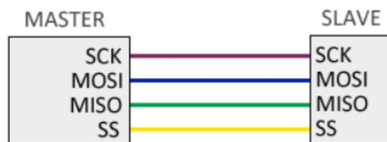
Figura 18. Diseño bus SPI. Fuente: [23]
