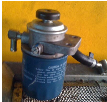
Figura 15. Conjunto bombín – filtro de combustible
