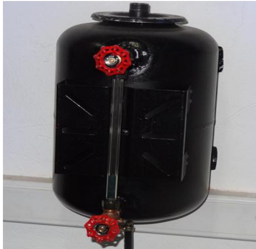
Figura 14. Tanque de combustible
