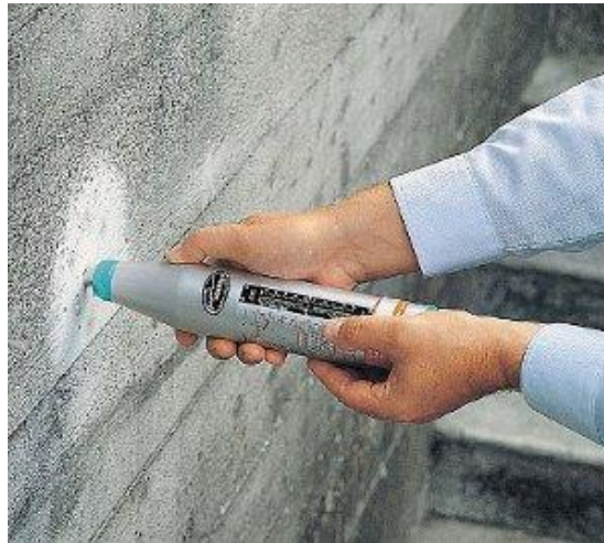
Figura N° 1. Ensayo de esclerometría.
