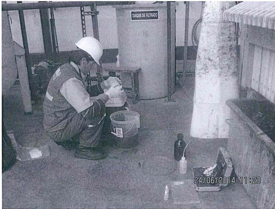
Fotografía N° 7: Toma de la muestra para Solidos Suspendedos Totales (SST) de la muestra del Efluente (Agua Residual). Punto de Monitoreo (EF-1).
