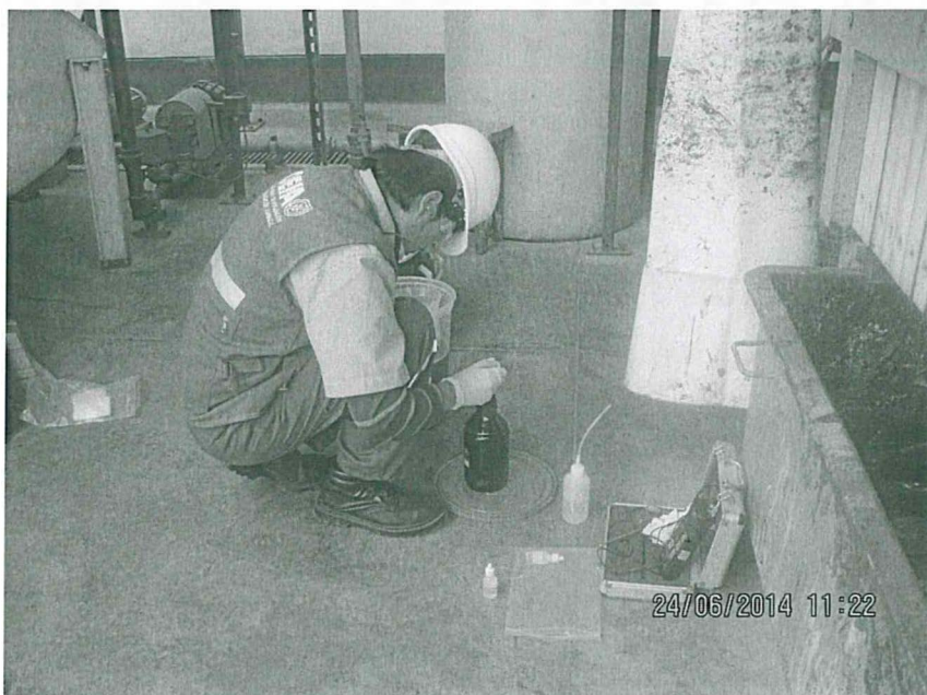
Fotografía N° 6: Aplicación del pereservante H_2SO_4 a la muestra para Aceites y Grasas (A&G).
