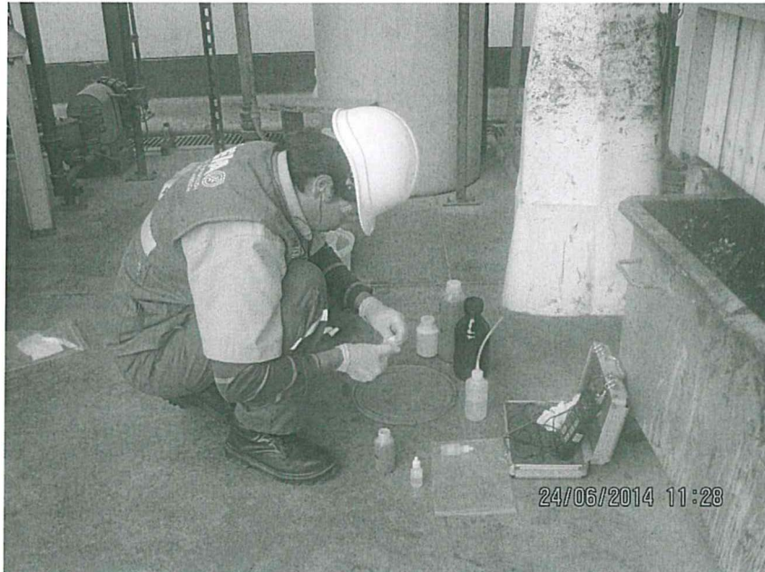
Fotografía N° 9: Aplicación del perseverante Acetato de Zinc y NaOH a la muestra para Sulfuros.
