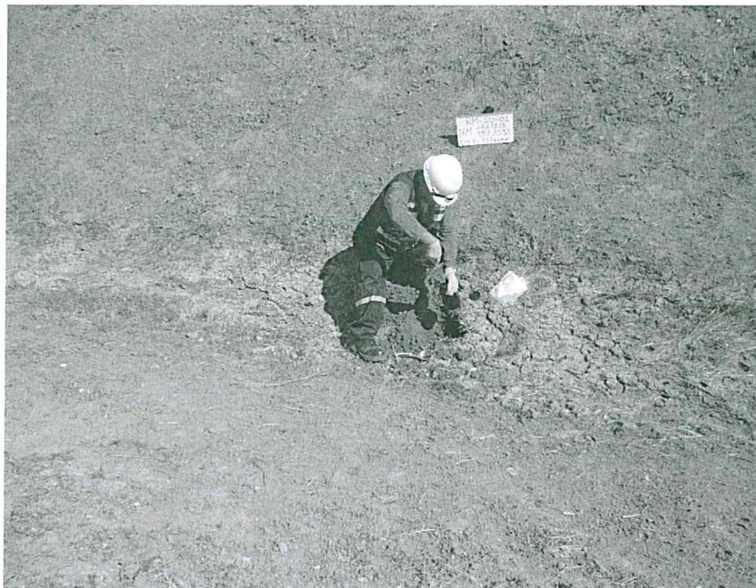
Fotografía N° 2. Punto de muestreo de suelo mediante calicata de 0,40 metros de Profundidad.
