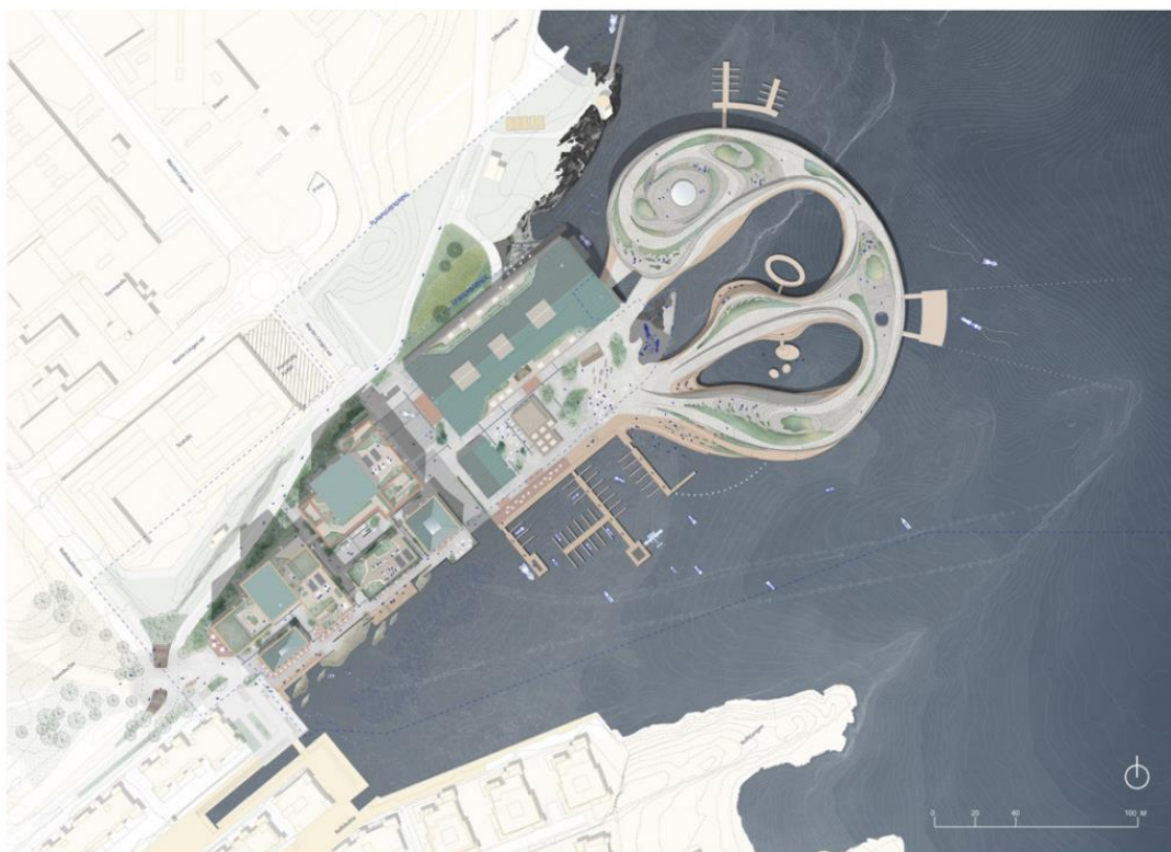
Figur 24. Alternativ 2 for Fornebu Brygge AS. Utbygging i sjø omfatter bryggeanlegg og tilrettelegging av hardbunnstrand i Rolfsbukta (alt. 1) og bygningsmasser i #5. Illustrasjon: Haptic + Oslo Works
