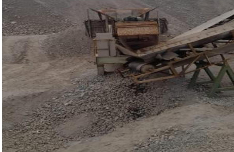
Figura N 73: Chancadora secundaria. Fuente: Elaboración propia, lugar ADEICS.
